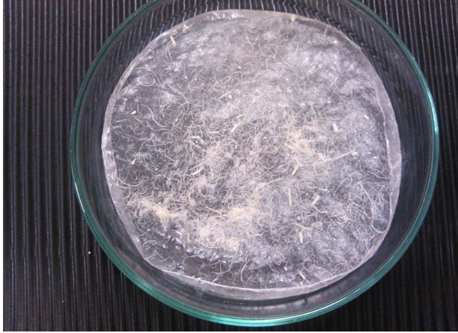
Şekil 2.2. Çözeltiden dökme ile üretilen 10ATT/90TPU film
