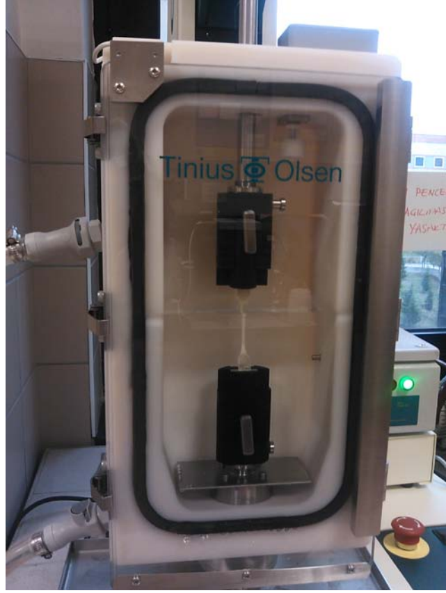
Şekil 2.5. 37 °C sıcaklığındaki su banyosu içinde yapılan film çekme testi
