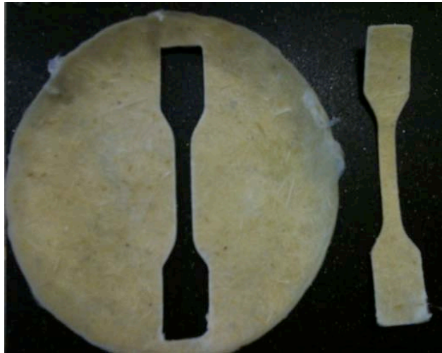
Şekil 3.3. 80ATT/20TPU çekme testi numunesi (dog-bone)
