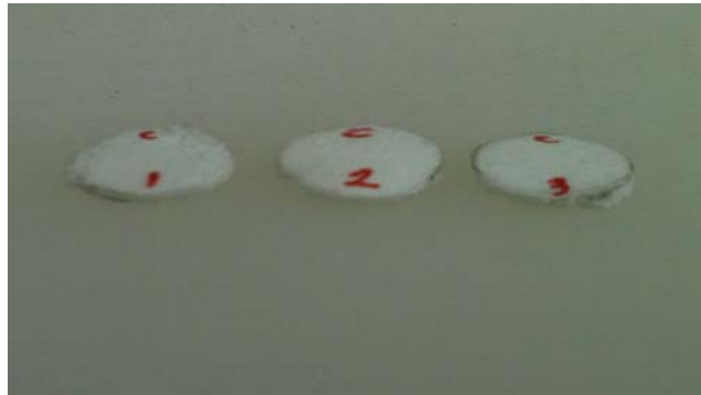
Şekil 2.6. Basma testi numuneleri
