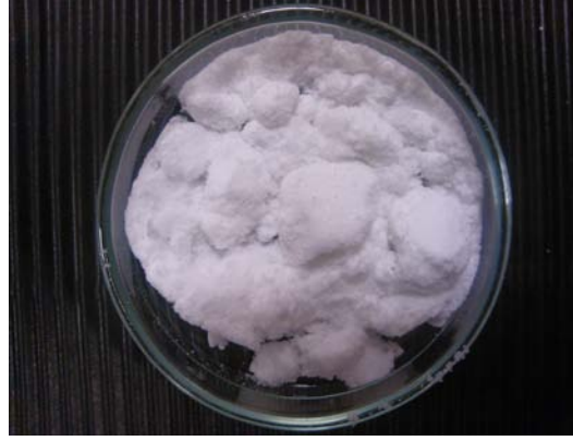
Şekil 3.11. 125-250 \mu\text{m} boyutlarındaki porojen NaCl
