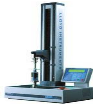
Şekil 3.7. Çalışma kapsamında kullanılan Lloyd Instruments LRX Plus marka çekme testi cihazının genel görünümü
