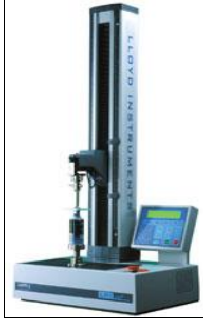
Şekil 2.7. Instrument-LRX Plus marka çekme cihazı
