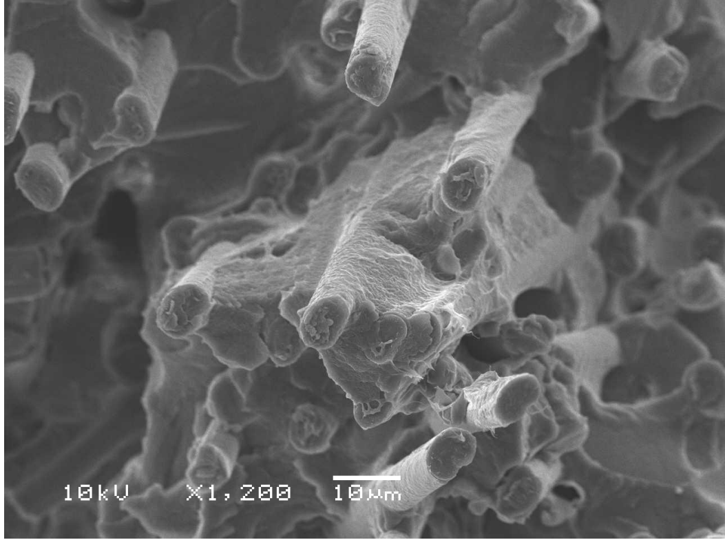
Şekil 3.104. % 1 oranında Joncryl bağlanma ajanı eklenmiş PU ön kaplanmış elyaf takviyeli PBT karmaya ait SEM mikrografı (x1200)
