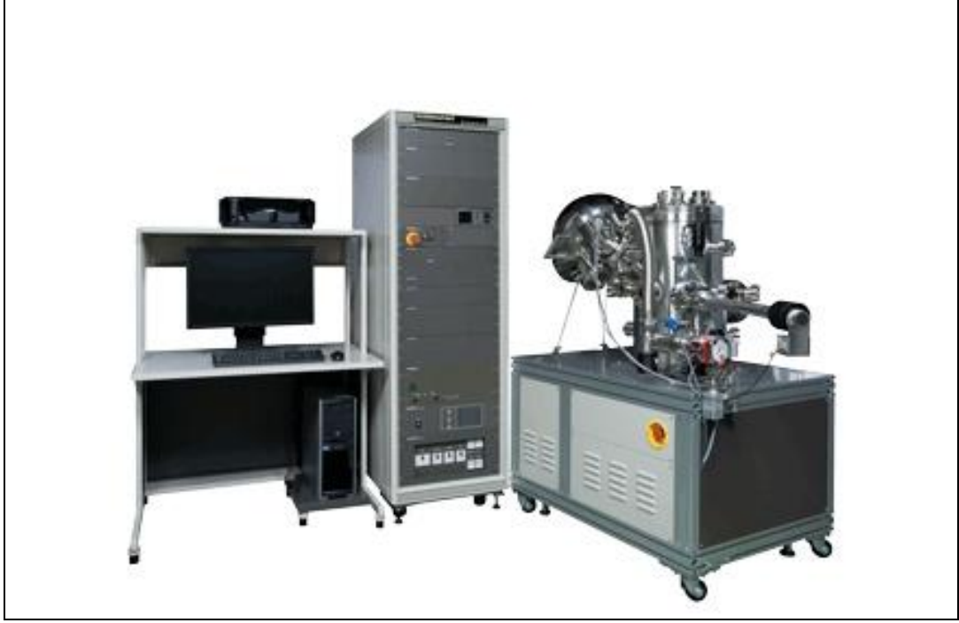
Şekil 2.3. PHI 5000 Versa Probe marka X-ışını fotoelektron spektroskopu
