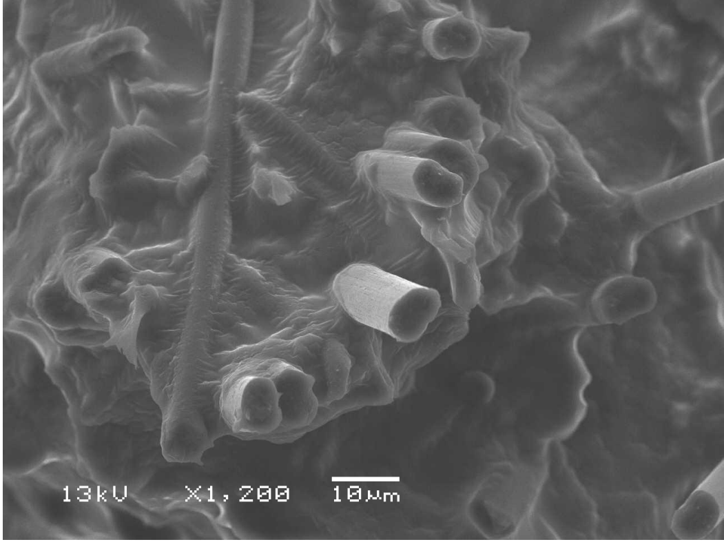
Şekil 3.84. % 1 oranında CBC bağlanma ajanı eklenmiş ön kaplanmamış elyaf takviyeli PA 6,6 karmaya ait SEM mikrografı (x1200)
