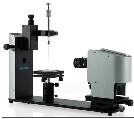
Şekil 2.5. Attention Theta Lite marka temas açısı ölçüm cihazı
