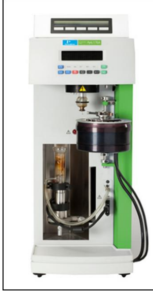
Şekil 2.4. Perkin Elmer marka TGA cihazı
