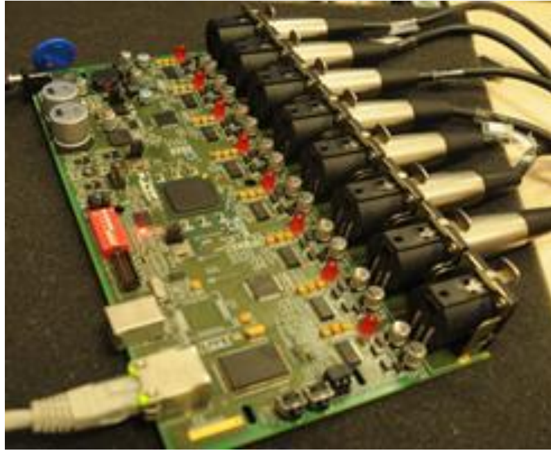
Şekil 4.3. Dizgisi tamamlanmış kartın görünümü ve mikrofonların, Ethernet kablosunun karta bağlantısı
