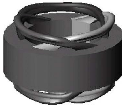
Şekil 1.18. 6/4 kutuplu KKARM üç boyutlu sargı yapısı [34]
