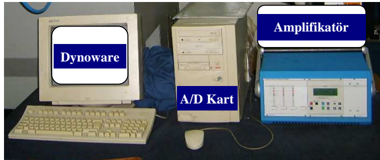
Şekil 7.3. Kalibrasyon deney düzeneği: a) Dik işleme merkezi, iş parçası ve dinamometre; b) Amplifikatör, A/D kart ve DynoWare yazılımı
