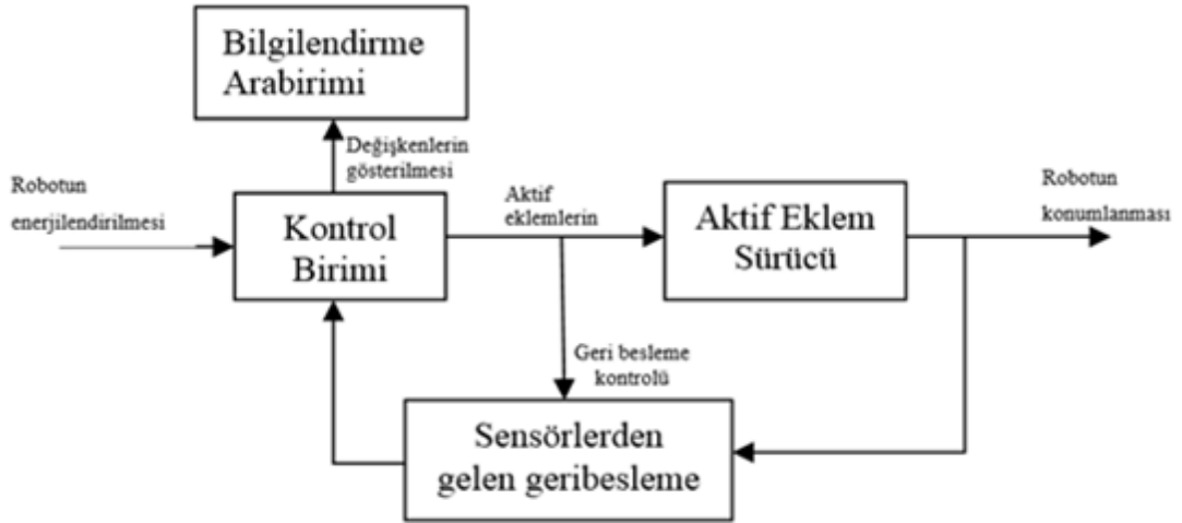
Şekil 4.1. Robotun elektronik bilgi akışı blok diyagramı
