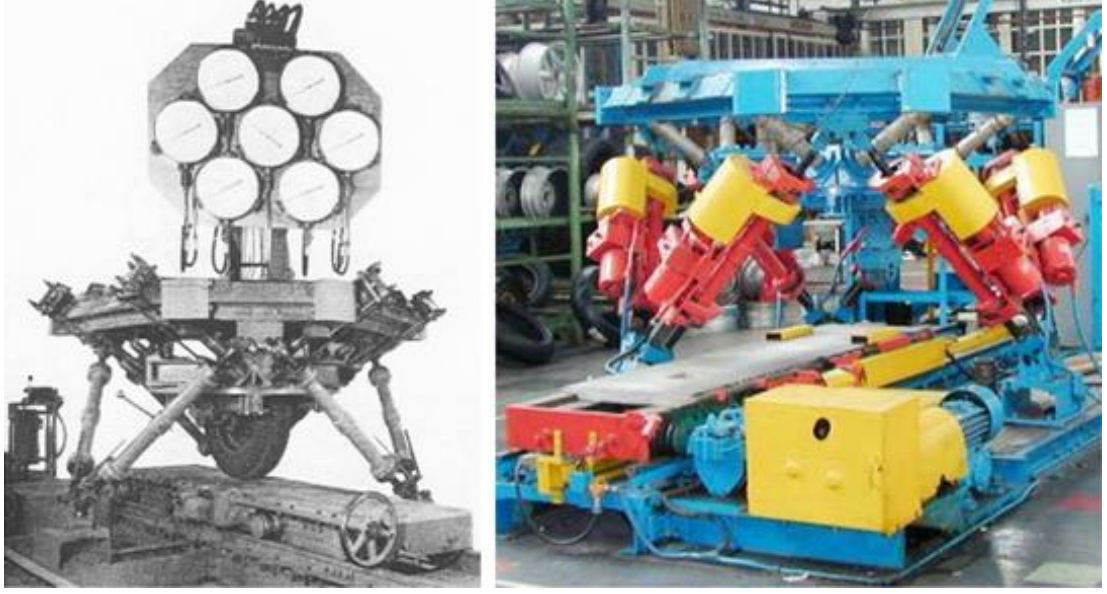
Şekil 1.11. a) İlk 6 serbestlik dereceli paralel mekanizma b) Gough platformunun 2000 yılında kullanılan hali [12]
