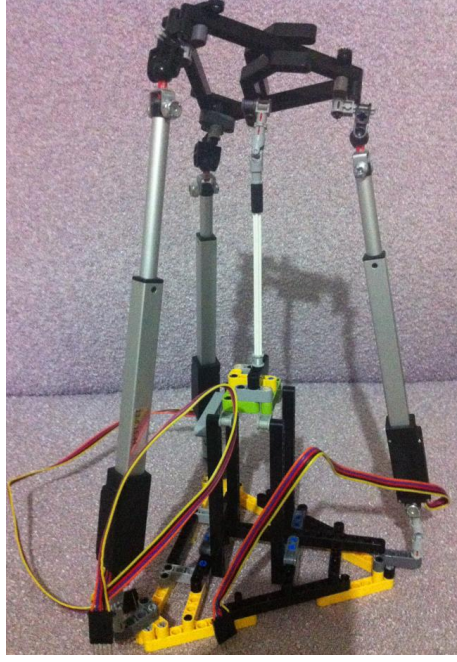
Şekil 5.14. 3-UPS,1-RU robotun mekanik tasarımı
