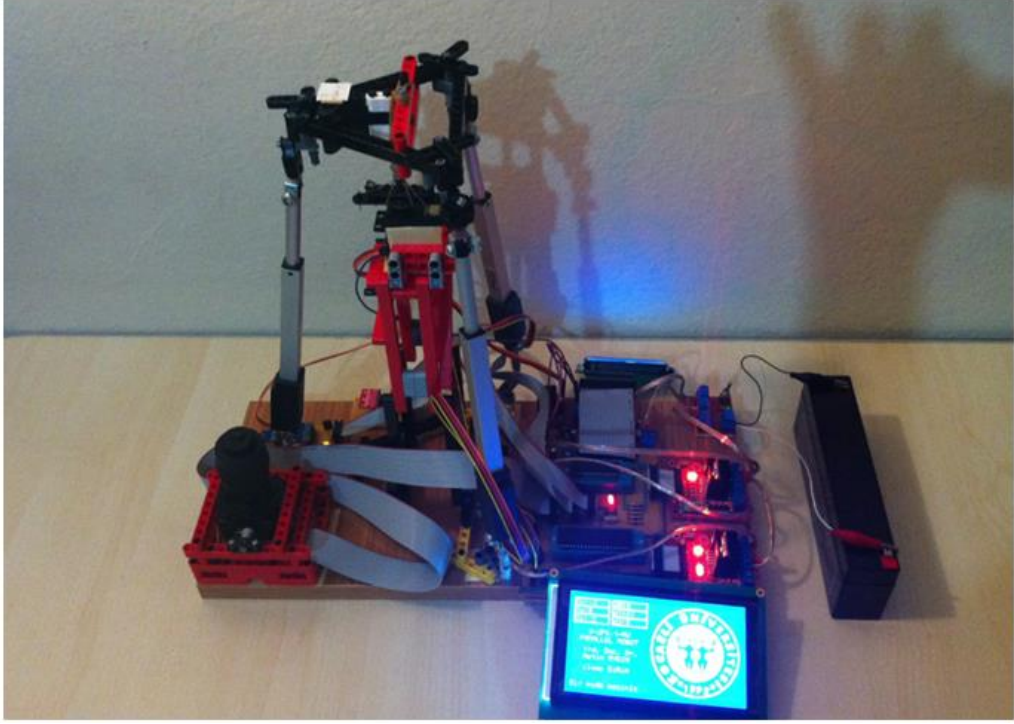
Şekil 5.16. 3-UPS,1-RU robotun tüm donanımları ile birlikte çalıştırılması
