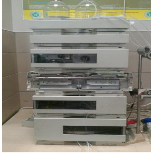
Şekil 3.3. Sıvı analizinde kullanılan HPLC cihazı
