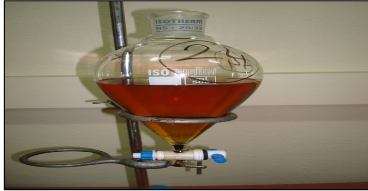
Şekil 6.12. 6:1 molar etanol oranı, %1 \text{CH}_3\text{ONa} , 75^\circ\text{C} ve 4 saatlik reaksiyon şartları ile gliserol faz ayrışması
