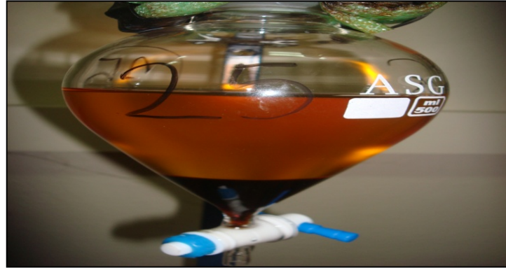
Şekil 6.13. Diğer reaksiyon şartları korunarak, \text{CH}_3\text{ONa} konsantrasyonu %1'den %1,25'e yükseltildiğinde daha yoğun gliserol faz ayrışmasının oluşması
