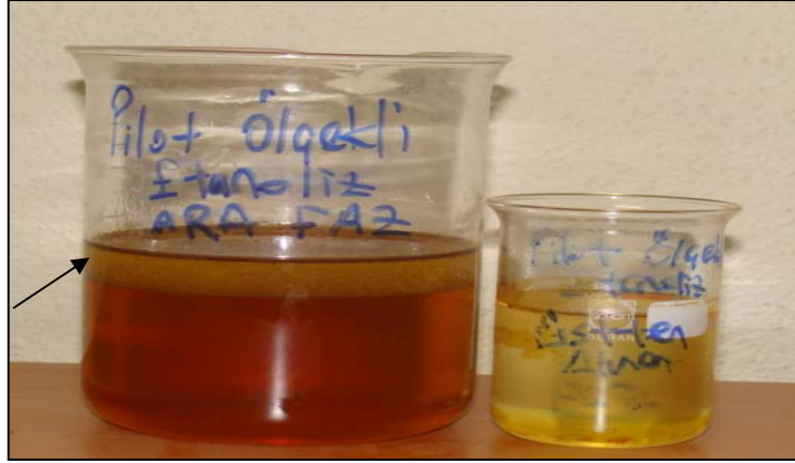
Şekil 6.29. Pilot ölçekli etanoliz sırasında oluşan ara faz
