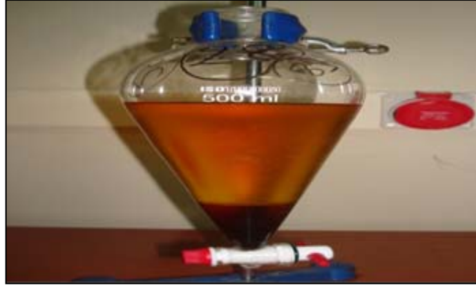
Şekil 6.14. %1,25 \text{CH}_3\text{ONa} konsantrasyonu ve diğer reaksiyon şartları korunarak, etanol:hammadde oranı 9:1'e çıkartıldığında oluşan gliserol fazı
