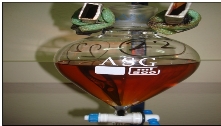
Şekil 6.10. 6:1 molar etanol oranı, %1 \text{CH}_3\text{OK} , 75 °C ve 4 saatlik reaksiyon şartları ile gliserol faz ayrışması
