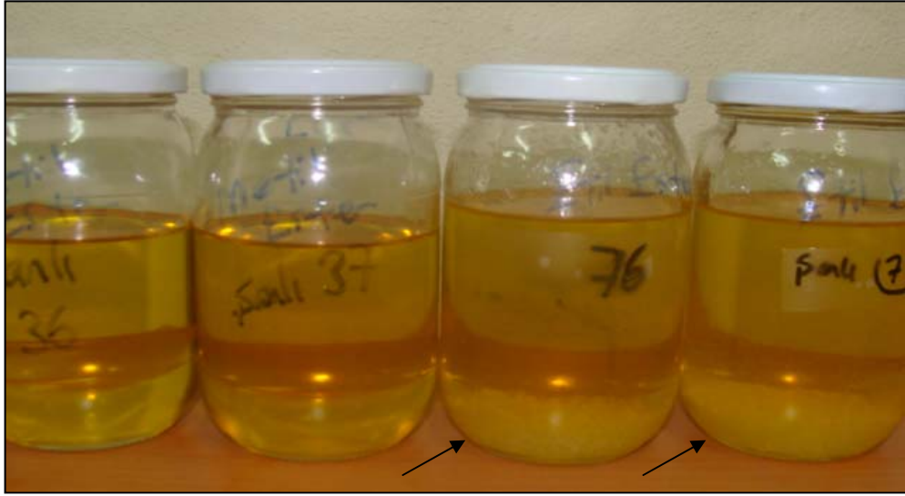
Şekil 6.27. Etil ester yakıtlarının dibinde tabaka oluşumu
