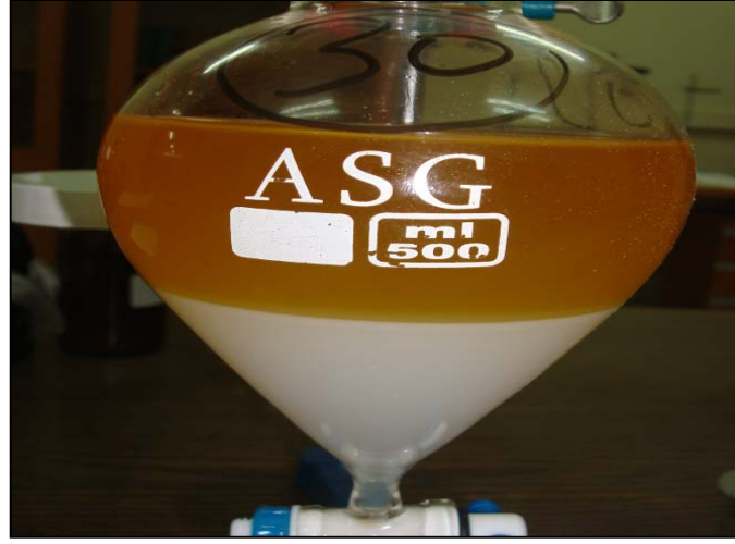
Şekil 5.5. Ester yakıtının saf su ile yıkanması
