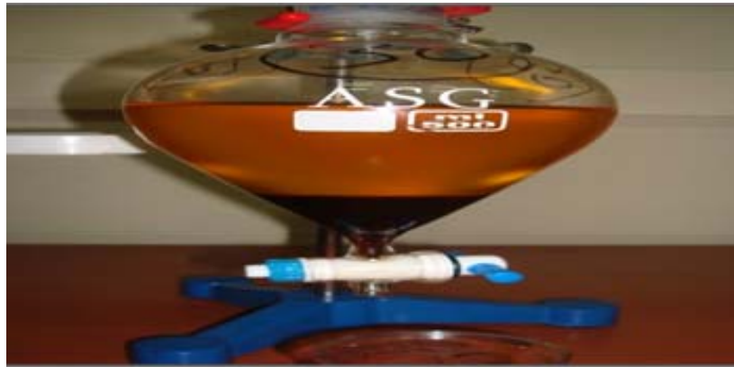
Şekil 6.16. 6:1 molar etanol:hammadde oranı, %1,50 \text{CH}_3\text{ONa} , 75 °C ve 4 saatlik reaksiyon şartları ile viskozite standardının sağlandığı ilk deney sonucu faz ayrışması
