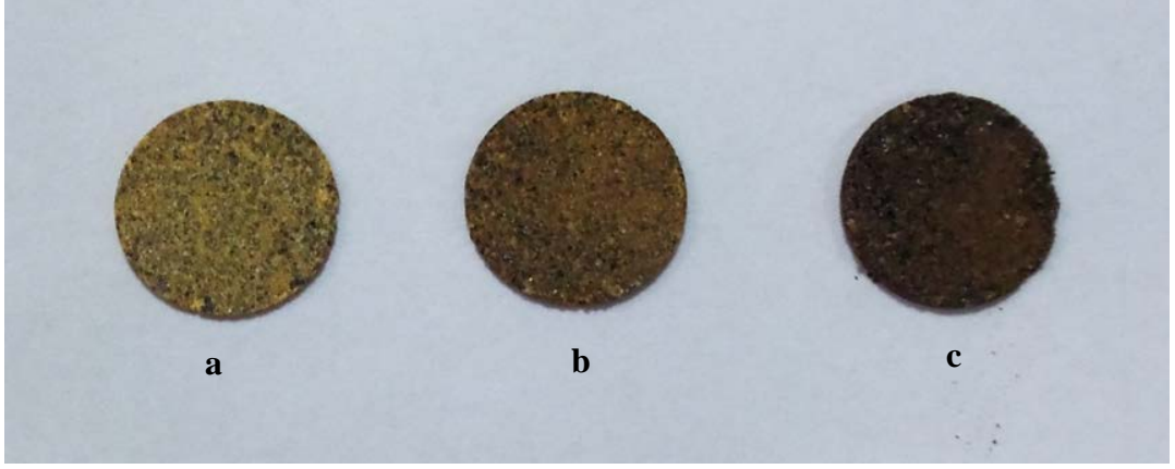
Şekil 2.1. Antibakteriyel duyarlılık testleri için hazırlanan kompozit diskleri (a) CS/%3Orgsep/Ag(0,025) , (b) CS/%3Orgsep/Ag(0,05), (c) CS/%3Orgsep/Ag(0,1)
