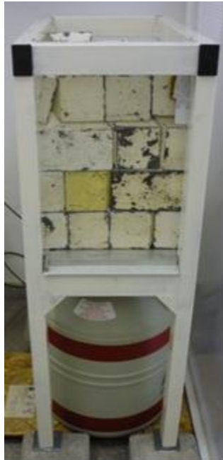
Şekil 3.20. LEPS (GLR 2015R) sayım sistemi
