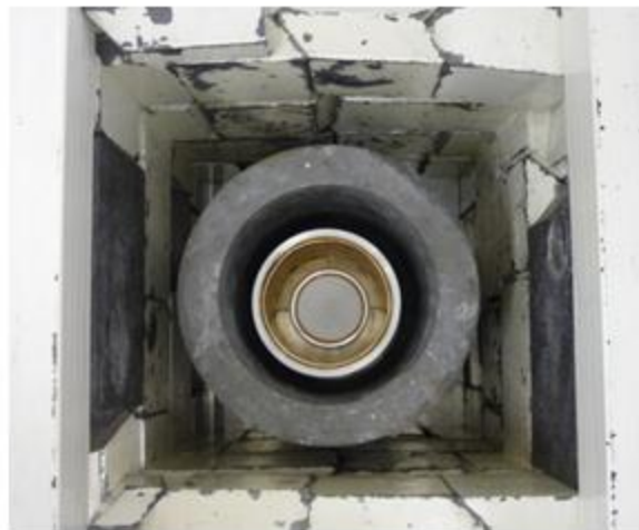
Şekil 3.20. LEPS (GLR 2015R) sayım sistemi
