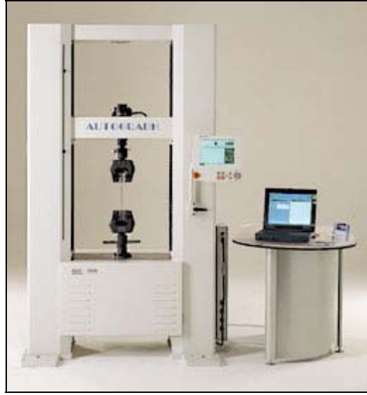
Şekil 5.4. Bulk numunelerin çekilmesinde kullanılan üniversal çekme cihazı.
