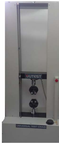
Şekil 5.3. Numunelerin çekilmesinde kullanılan universal (UTEST 15) çekme cihazı
