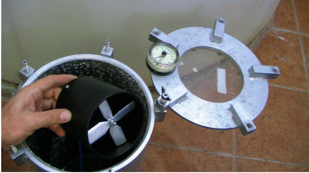
Şekil 1.2. 20bar Basınç için Sızdırmazlık Testi
