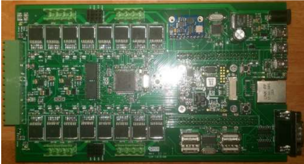
Şekil 2.45. Montajı Yapılmış Kontrol Kartı
