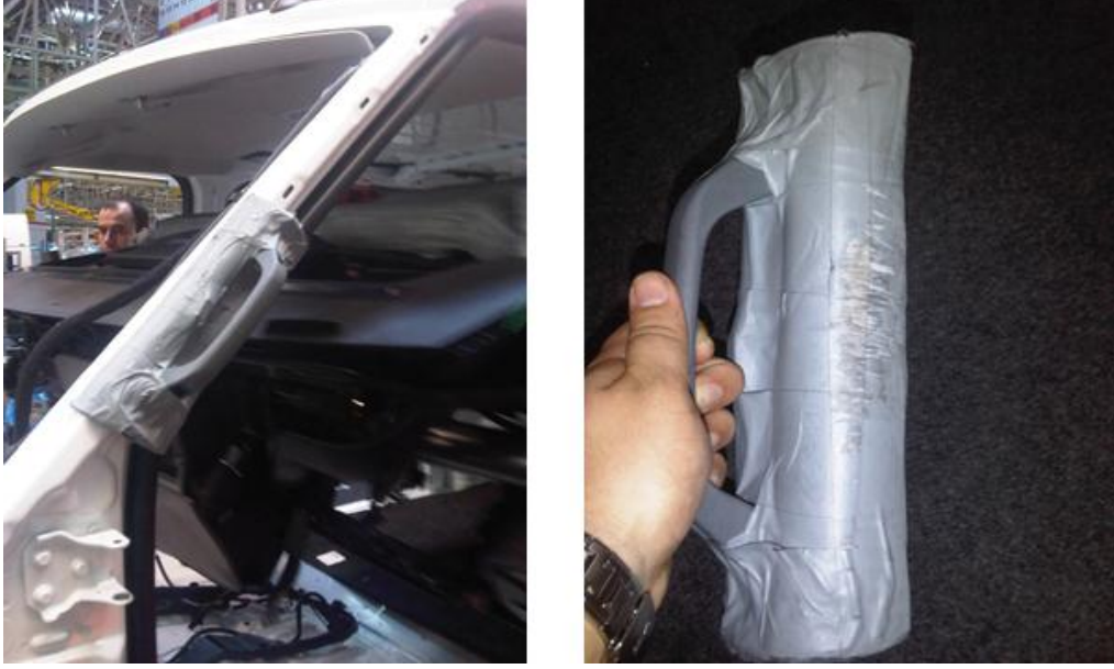
Şekil 5.4. Mıknatıslı fitil koruyucu (IP montajı)
