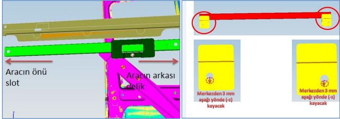
Şekil 5.5. Mekanizma demiri delik konumu
