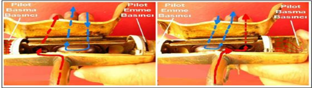
Şekil 3.15. Pilot basıncı ile sürgünün hareketlenerek akış yönünü değiştirmesi (Megep, 2011)
