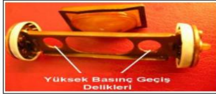
Şekil 3.14. Dört yollu valf içerisindeki hareketli piston (Megep, 2011)
