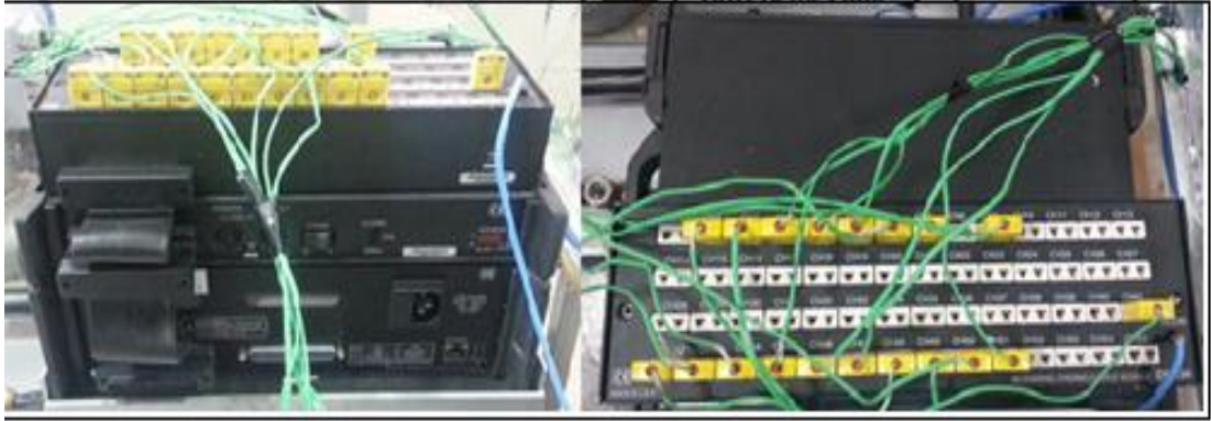
Şekil 4.4. Deneysel sistemde termokupllardan gelen sıcaklık değerlerini bilgisayar ortamına aktarılmasını sağlayan data logger
