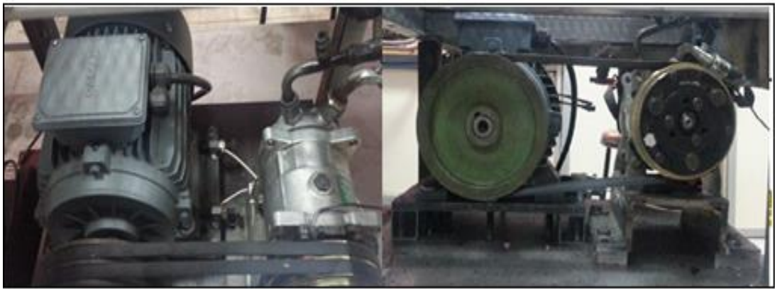
Şekil 4.3. Deneysel sistemde kullanılan kompresör ve elektrik motorunun birbirine bağlı gösterimi
