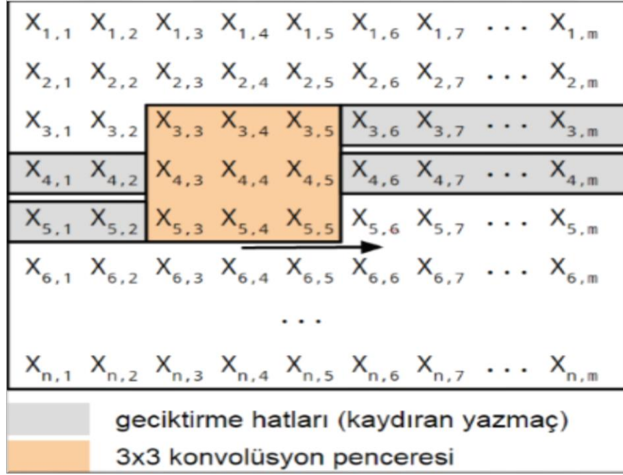
Şekil 4.3. Konvolüsyon işlemini yapan modülün çalışma sistemi
