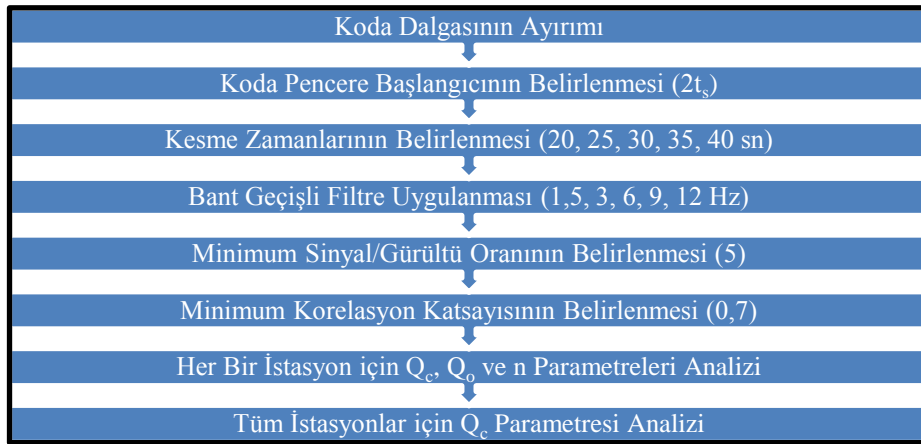
Şekil 3.2. Kalite faktörünün hesaplanması için SEISAN yazılım paketinde yapılan veri-işlem adımlarının akış şeması
