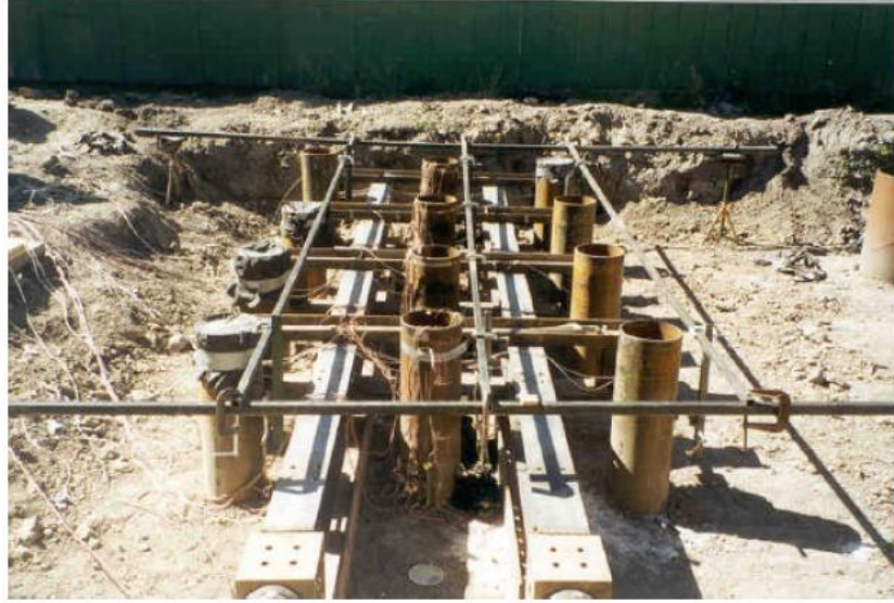
Şekil 5.20. Testi sırasında serbest başı 12-kazık grubu
