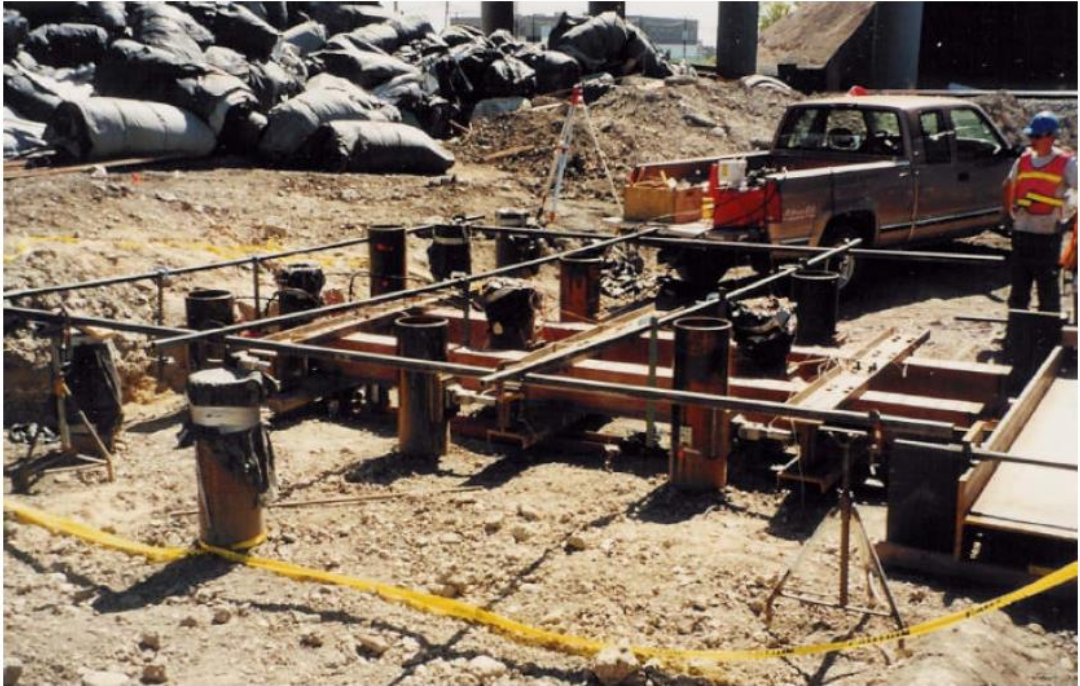
Şekil 5.18. Dokuz kazıktan oluşan kazık grubu için yatay yük testi
