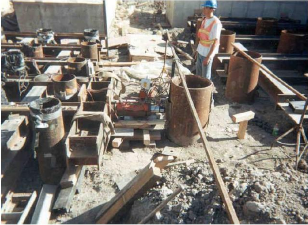
Şekil 5.13. Tekil kazık (D=0,61 m) yanal yük testi
