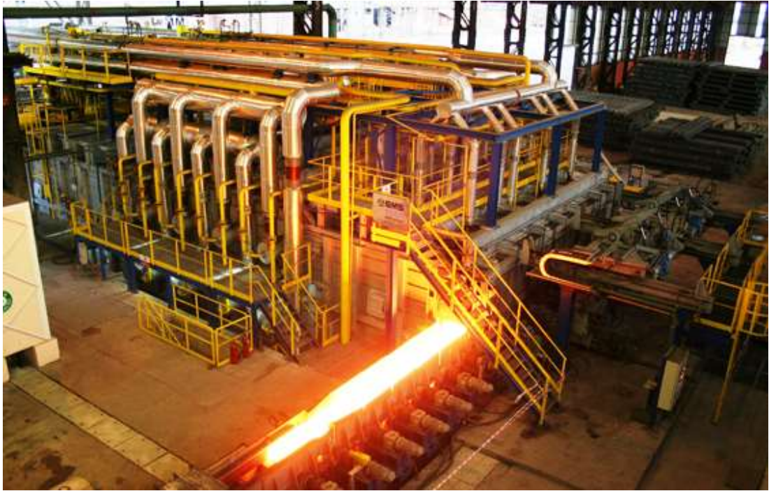
Şekil 1.4. Endüstriyel bir tav fırını resmi
