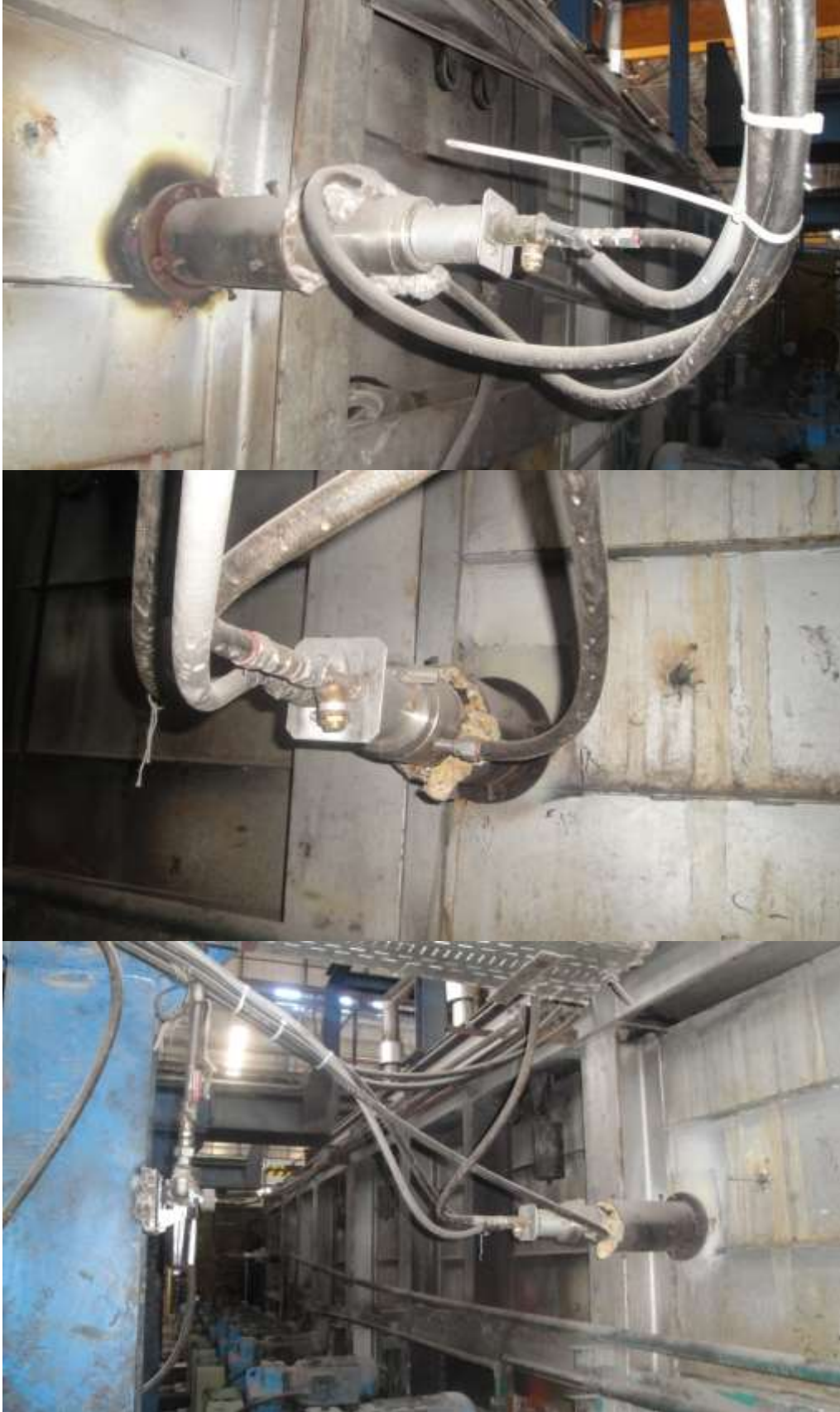
Şekil 6.4. Sisteme entegre edilen yüksek sıcaklığa dayanıklı kamera
