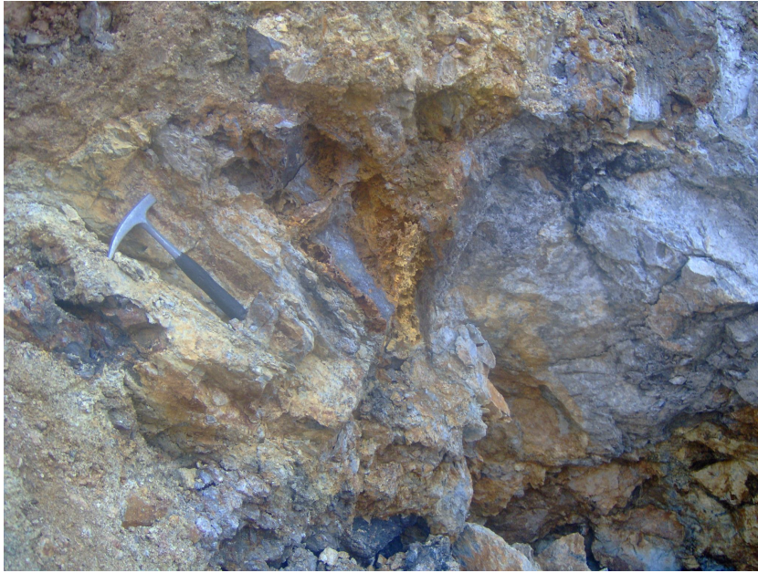
Şekil 3.1. İnceleme alanındaki cevherleşmelerden bir görünüm. Koyu gri renkli görünen kısımlar ince taneli başlıca galenden oluşmuş sülfürlü cevher damarlarıdır.
