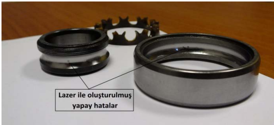
Şekil 3.1. Lazerle oluşturulmuş yapay hatalar
