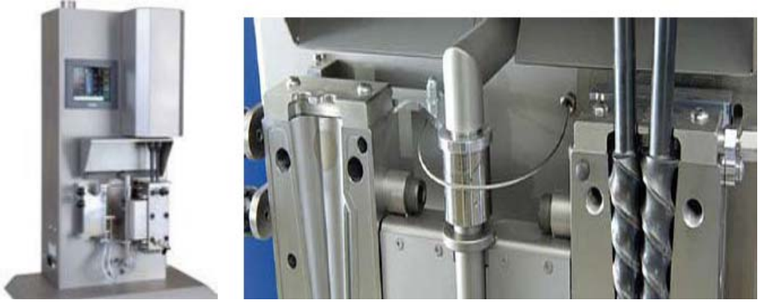
Şekil 2.1. DSM XPLORE ekstrüzyon cihazı (Şahin, 2013)
