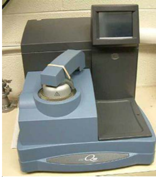
Şekil 2.9. TA Instruments Q200 test cihazı (Şahin, 2013)
