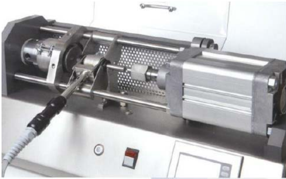
Şekil 2.2. DSM XPLORE enjeksiyon cihazı (Şahin, 2013)
