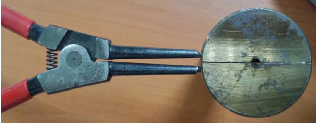
Şekil 2.7. Numunenin segman pensesiyle kalıptan çıkarılması
