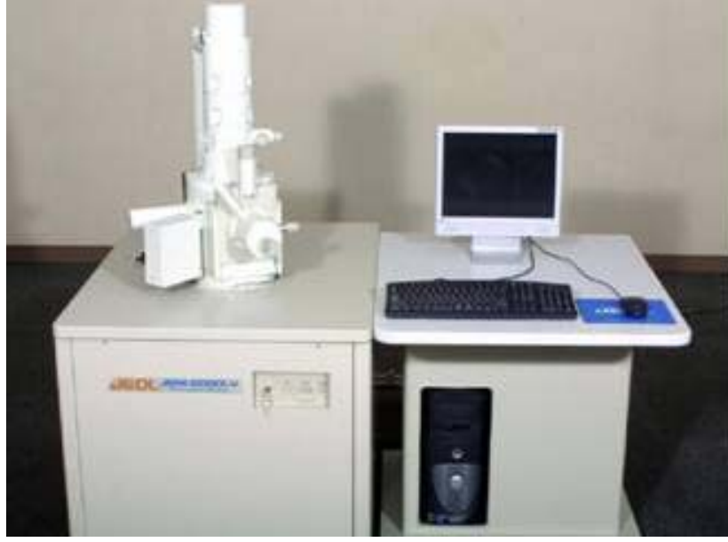
Şekil 2.19. JEOL JSM-6060 model taramalı elektron mikroskobu
