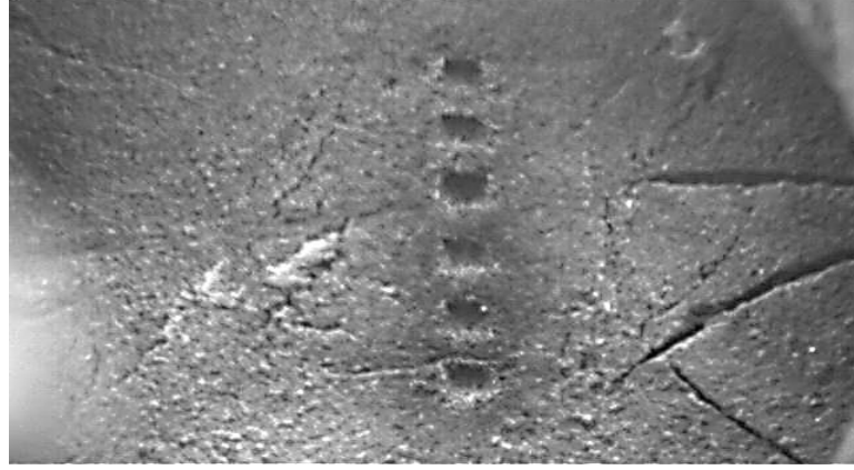
Şekil 3.14. Sediment üzerine uygulanan 6 spektrum atım noktası
