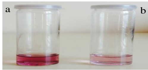
Şekil 3.7. Saf su (a) ve kloroform (b) içindeki altın nanoparçacıklar
