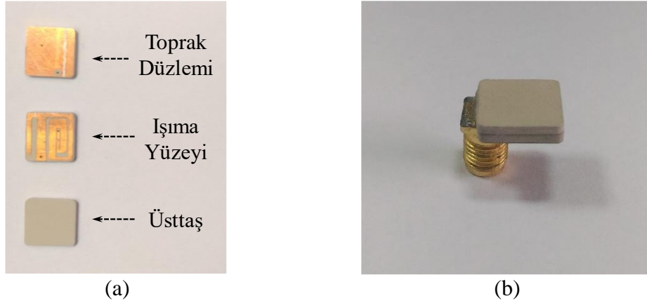
Şekil 3.23. Gerçeklenen tek-katmanlı çift-bant bükümlü-MİA'ya ait (a) katmanlı (b) perspektif görüntüler
