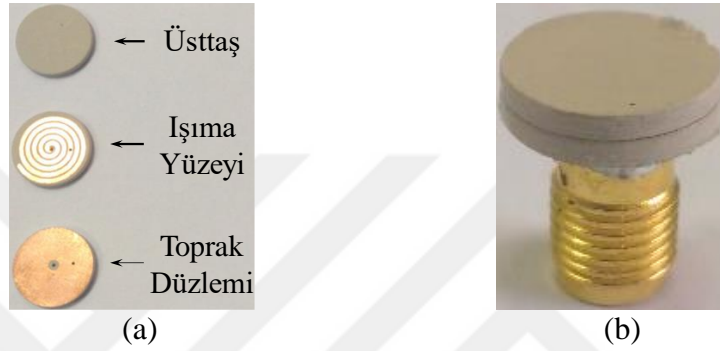
Şekil 2.11. Gerçeklenen MICS–bant AS–MİA'ya ait (a) katmanlı ve (b) perspektif görüntüler
