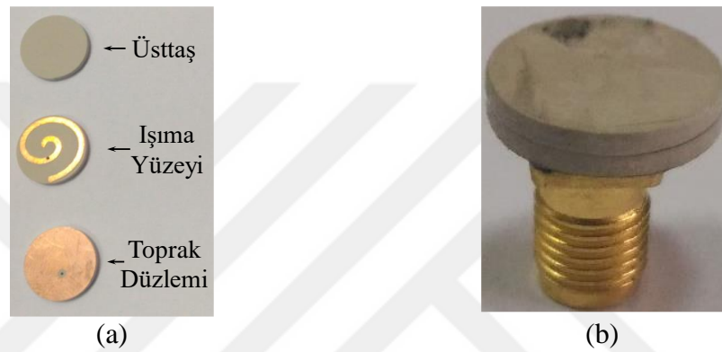
Şekil 2.25. Gerçeklenen ISM-bant AS-MIA'ya ait (a) katmanlı ve (b) perspektif görüntüleri
