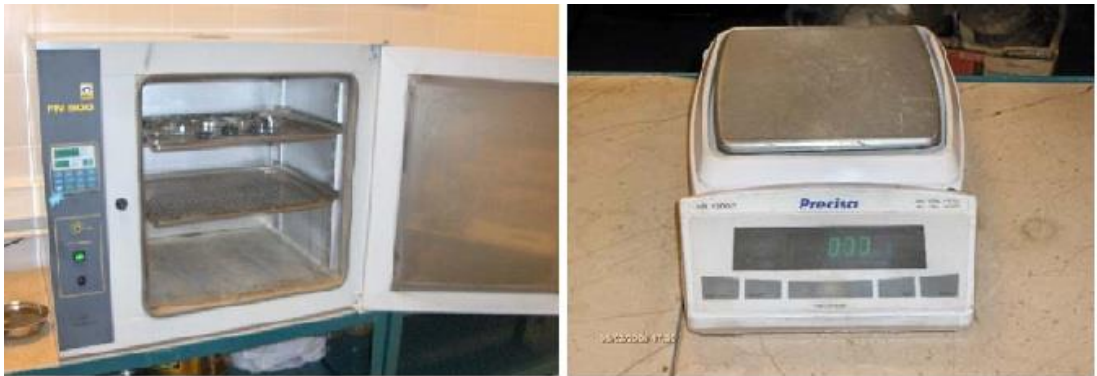
Şekil 3.1. Doğal su muhtevası ekipmanları (etüv ve terazi)
