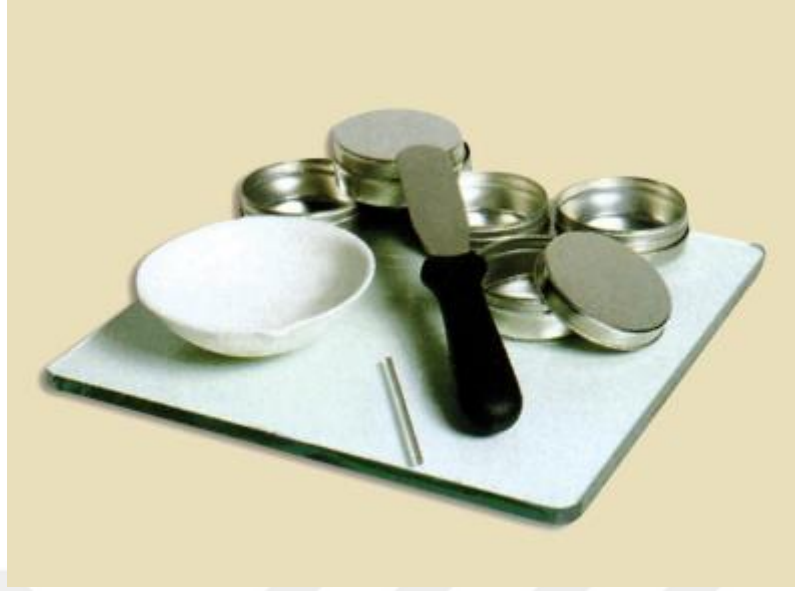
Şekil 3.3. Plastik limit deney seti
