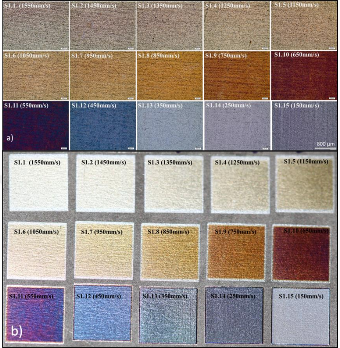
Şekil 3.8. Tablo 3.2’de verilen parametreler ile işlenen yüzey (a) optik mikroskop görüntüleri, (b) fotoğraf makinesi görüntüleri
