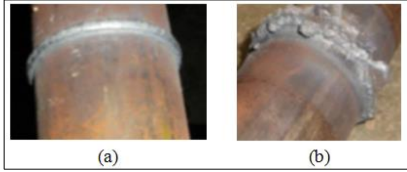
Şekil 2.18. MIAB kaynağında dudak oluşumu a) uniform dudak oluşumu ve tamalanmış kaynak penetrasyonu b) fazla erime ve yanma [24]
