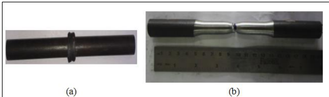
Şekil 2.10. INCOLOY 800H malzemesiyle imal edilmiş optimum sürtünme kaynağı a) doğrulama numunesi b) çekme testi sonrası parçaların durumu [49]
