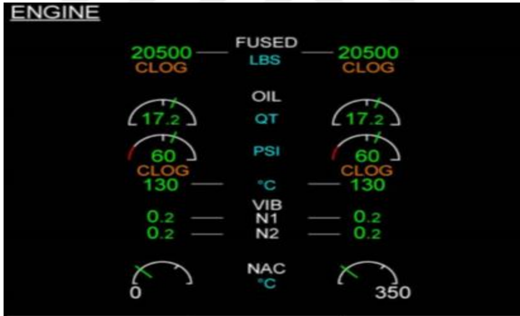
Şekil 1.3. Fused, oil qt, oil psi, o °c, vib n1&n2 ve nac parametrelerinin kokpitteki göstergesi
