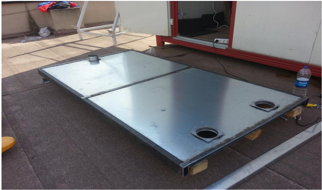
Şekil 4.2. Kollektörlerin hava giriş-çıkışının gerçekleşeceği arka yüzeyi
