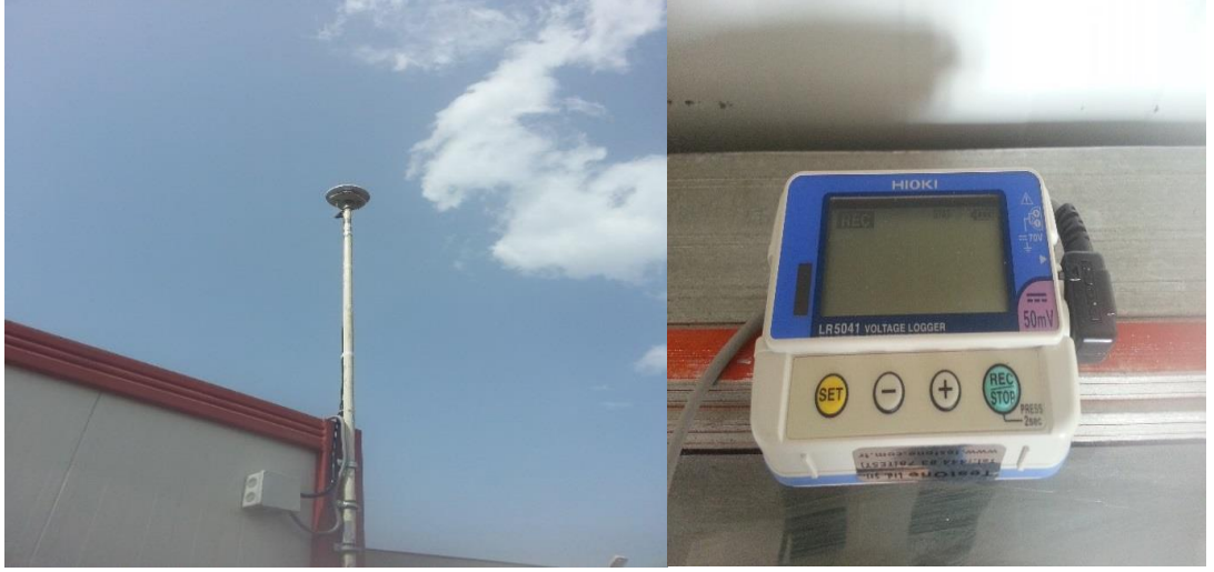
Şekil 4.15. Işınım şiddetini ölçmek için deneylerin yapıldığı mekâna yerleştirilen piranometre ve veri kaydedici ekipmanı
