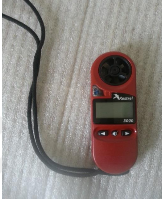
Şekil 4.14. Hava hızı ölçümünde kullanılan el tipi anemometre
