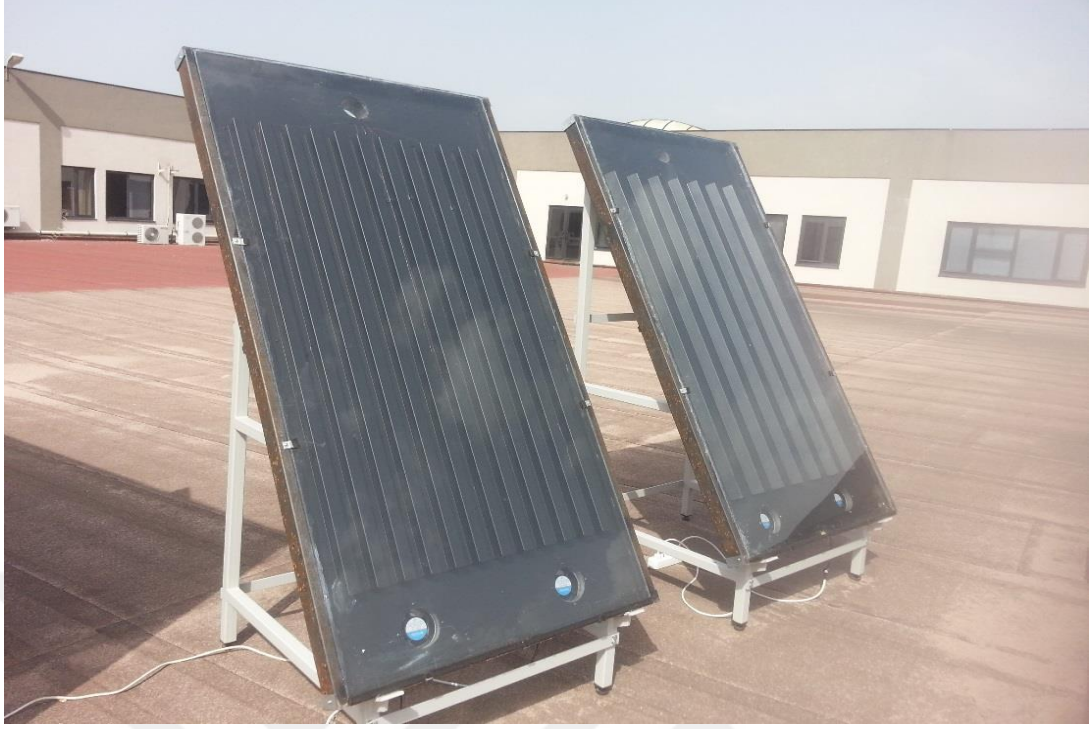
Şekil 4.9. Deneyleerde kullanılan trapez ve dikdörtgen plakalı kollektörler
