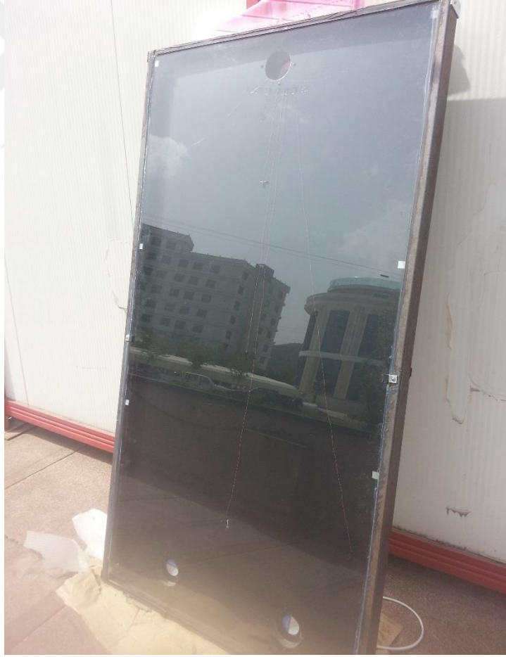
Şekil 4.8. Deneyleerde kullanılan düz plakalı kollektör
