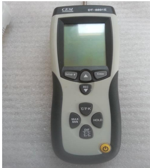
Şekil 4.13. Deneylerde kullanılan veri kaydedici ısı çifti
