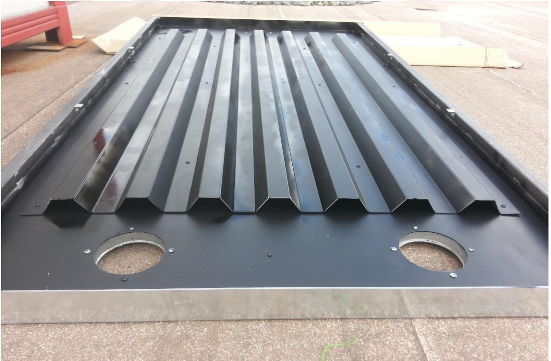
Şekil 4.6. İmalatı yapılan trapez yutucu plakalı kollektör
