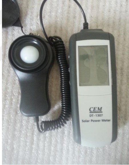
Şekil 4.16. Anlık ışınım şiddetini ölçmek için kullanılan portatif piranometre
