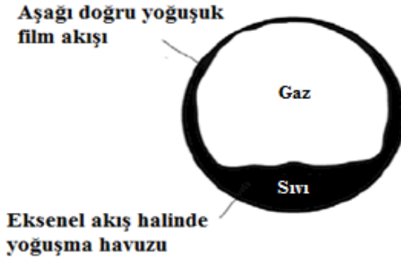
Şekil 5.2. Yatay tüp içerisinde yoğuşmada tam halkasal akış (Santa, 2012)
