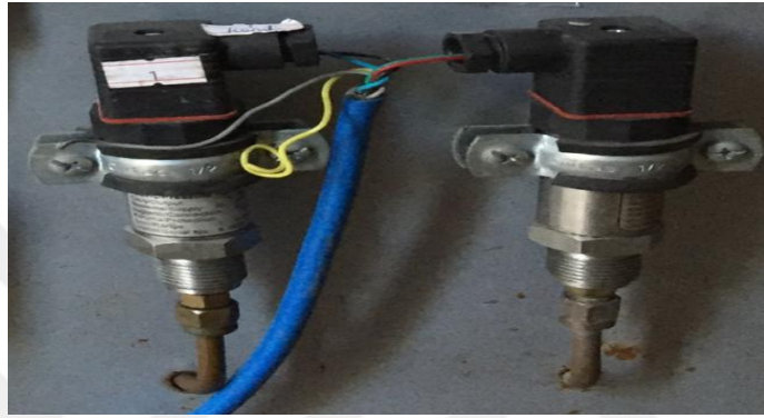
Şekil 2.4. Emme ve basma hattı basınçlarının ölçümünde kullanılan basınç transmitterleri
