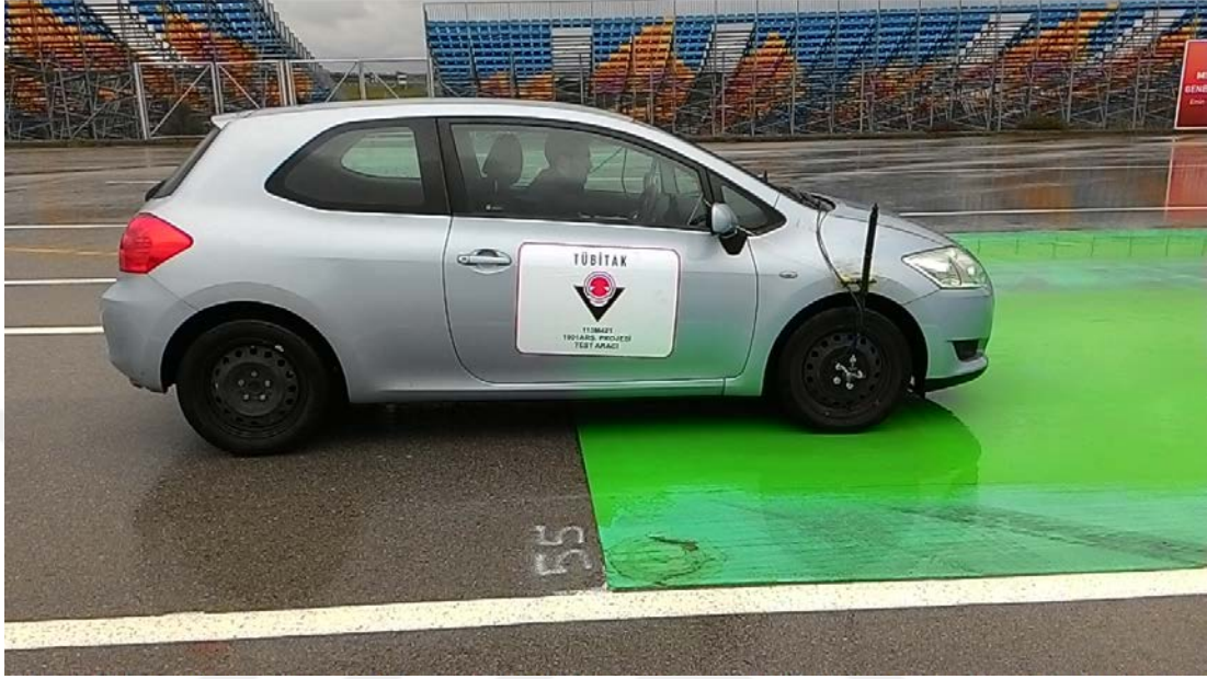
Şekil 3.14. Islak yoldan kaygan yola geiş testi
