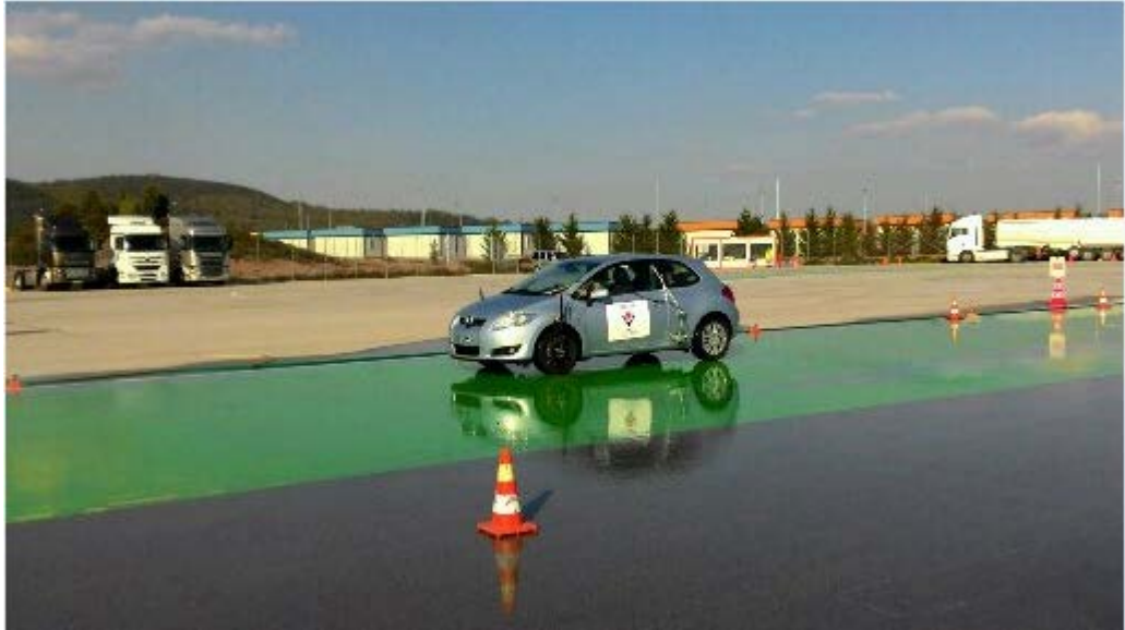
Şekil 3.13. Kaygan yol testi
