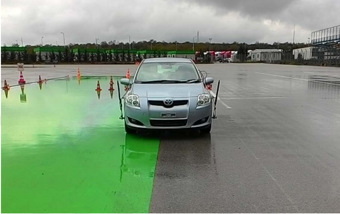
řekil 3.16. Ayrık yol testi
