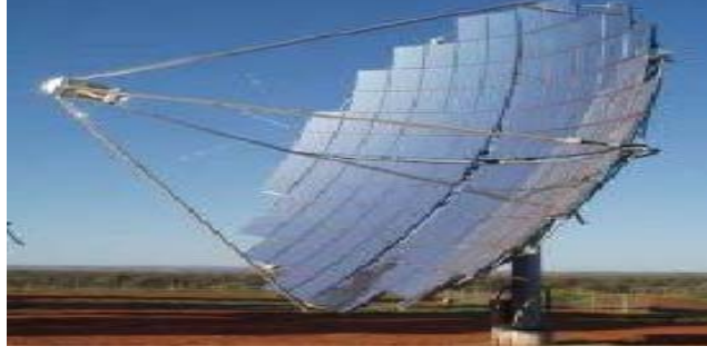
Şekil 1.4. Yoğunlaştırılmış fotovoltaik sistem
