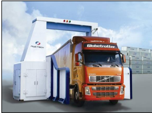
Şekil 1.4. Radarla konteyner görüntüleme [12, 13]
