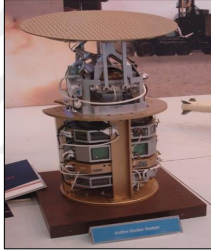
Şekil 2.3. Güdümlü mermilerde kullanılan K_u bant Radar [34]
