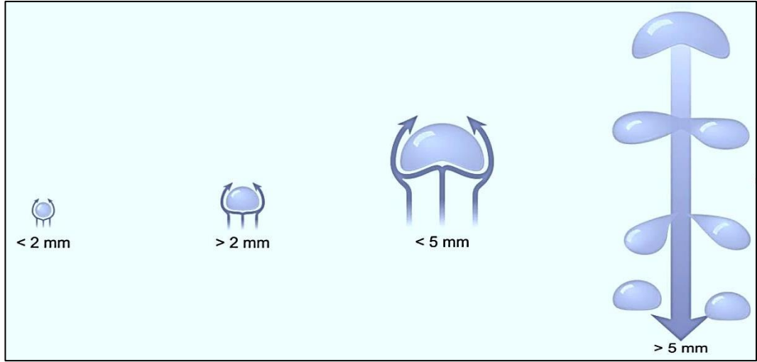
Şekil 2.7. Yağmur damlalarının atmosferde maruz kaldığı kuvvetler [38]
