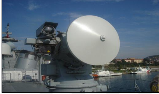
Şekil 2.5. Türk Deniz Kuvvetleri bağlısı YAVUZ ve BARBAROS Sınıfı Fırkateynlerde bulunan K_u bant hedef takip radarı
