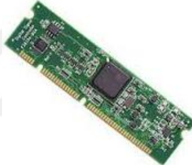
Şekil 4.27. TMS320F28335 işlemcisi denetim kartı
