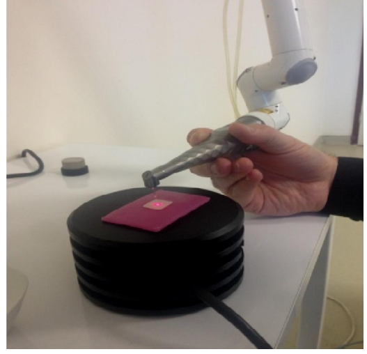
Resim 3.15. Power metre cihazı ile seramiklerin transmisyon deęerlerinin ölçülmesi
