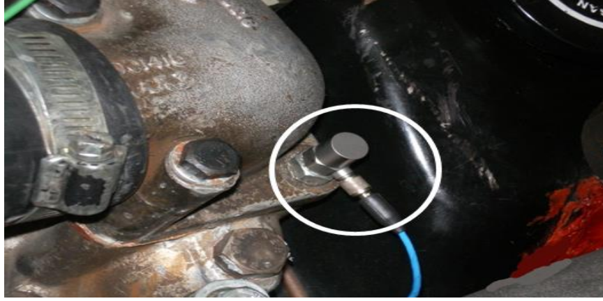
Şekil 6.5. İvmeölçerin motor üzerinde gösterimi
