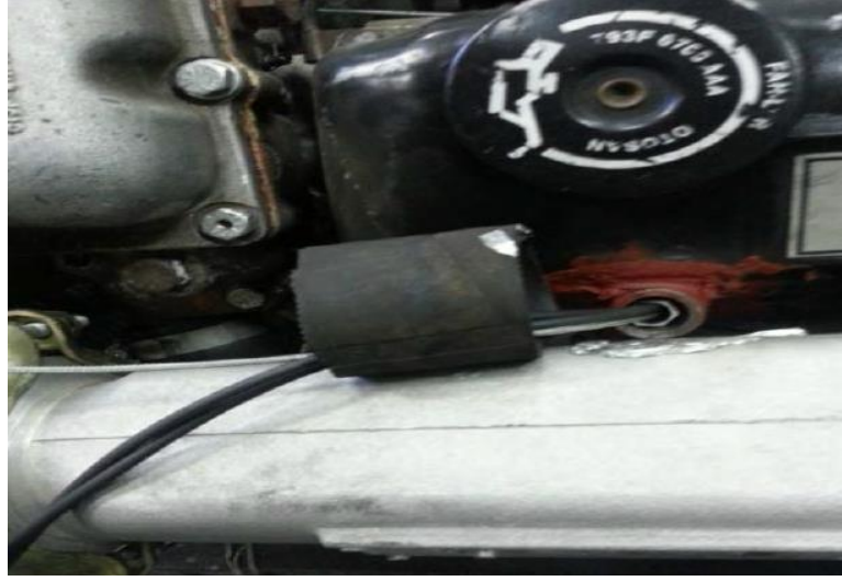
Şekil 6.4. Basınç sensörünün motor üzerinde gösterimi
