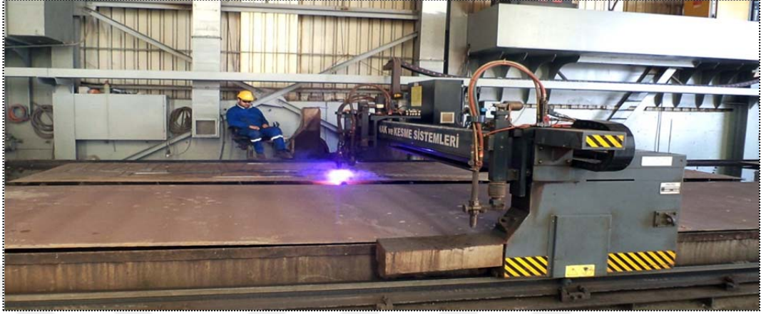
Őekil 4.8. elik sacın atlyede CNC makina ile kesimi
