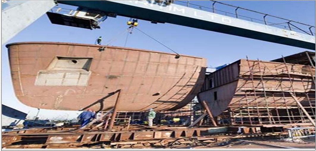
Şekil 4.11. Gemi pruvasının gemiye eklenmesi
