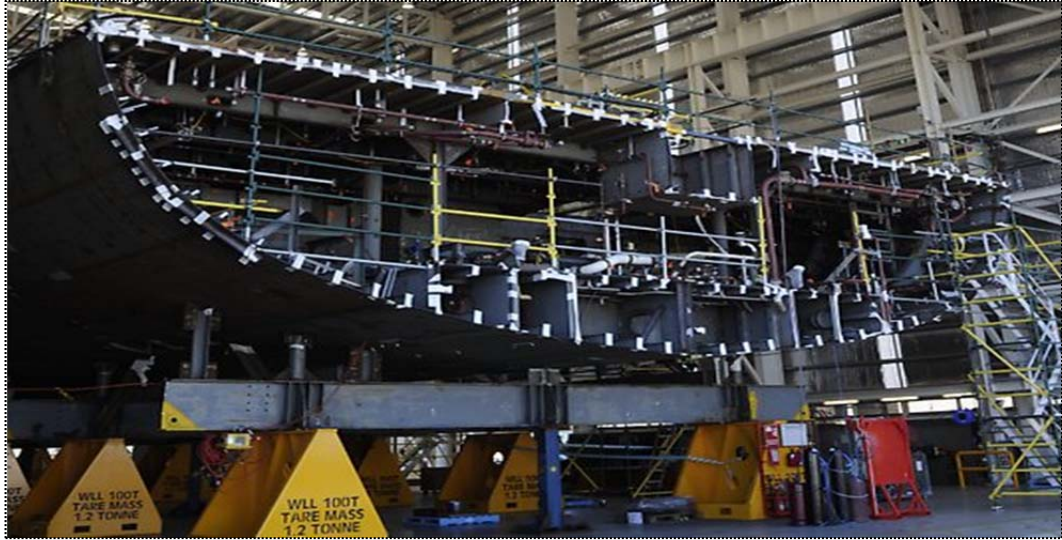
Şekil 4.10. Geminin blok imalatı
