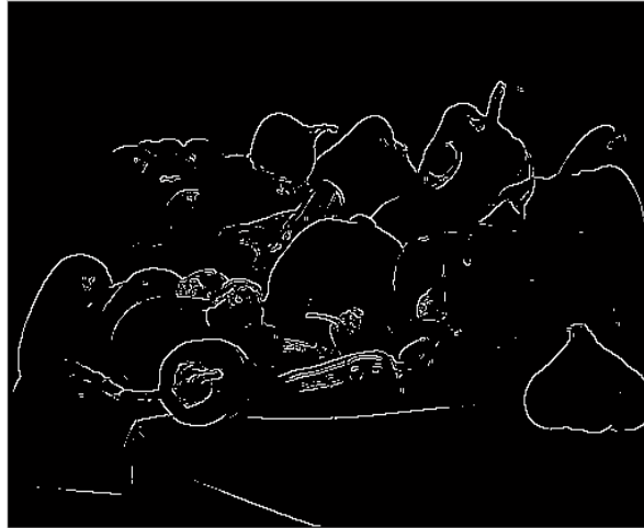
Şekil 5.7. Roberts Operatörü İle Kenar Tespiti Yapılmış Resim Örneği
