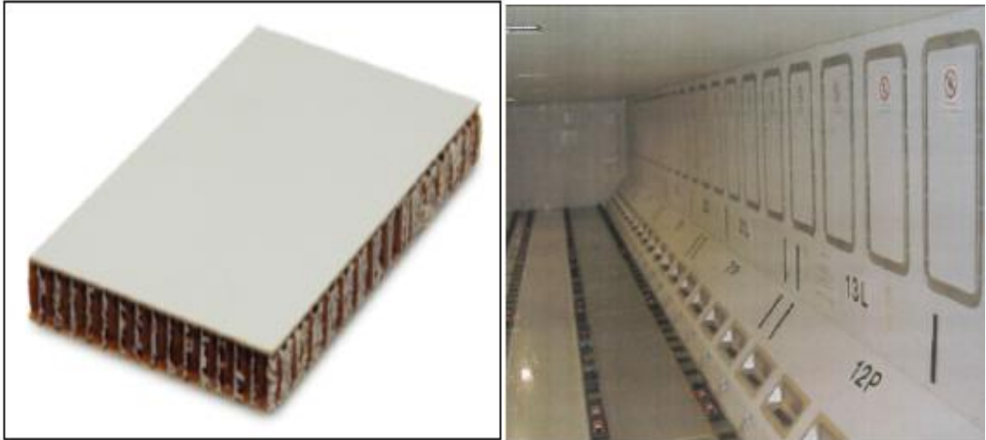
Şekil 3.1. Airbus A320 ailesi ticari uçakların kargo kompartmanlarında kullanılan Gillfab 4422 bal peteği sandviç kompozit yapılar ve kompartmandaki görüntüsü [59]
