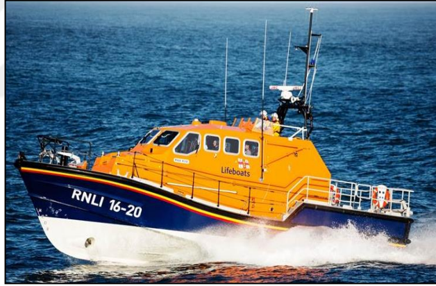
Şekil 1.9. Elyaf ile güçlendirilmiş köpük dolgulu kompozit filika (Tamar RNLI 16-20) [25]
