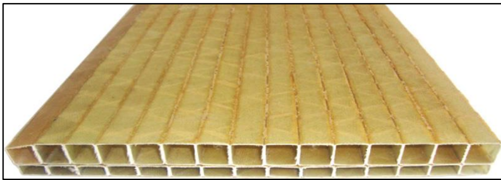
Şekil 2.11. Tüp geometrik şekilli çekirdeğe sahip sandviç panel numunesi
