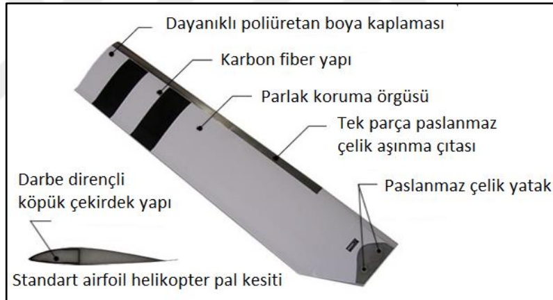
Şekil 1.14. Helikopter palinin yapısı ve kesiti [29]
