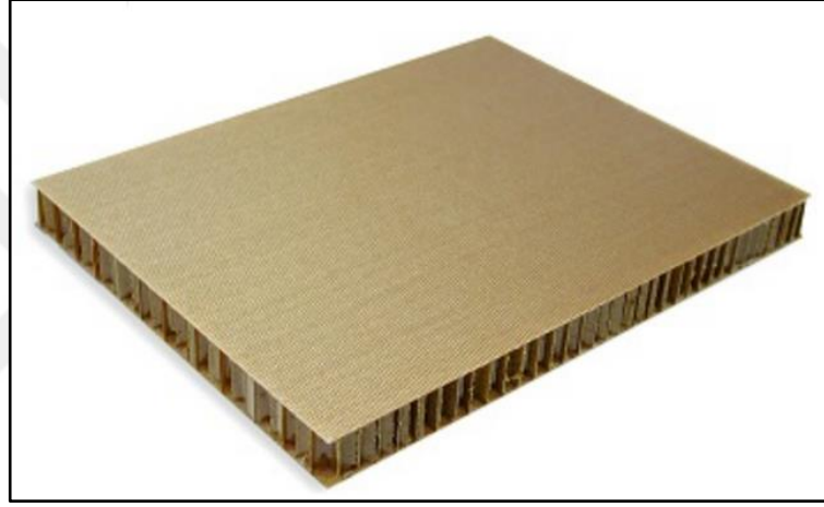
Şekil 1.19. İmalat sonrası bal peteği kompozit örneği
