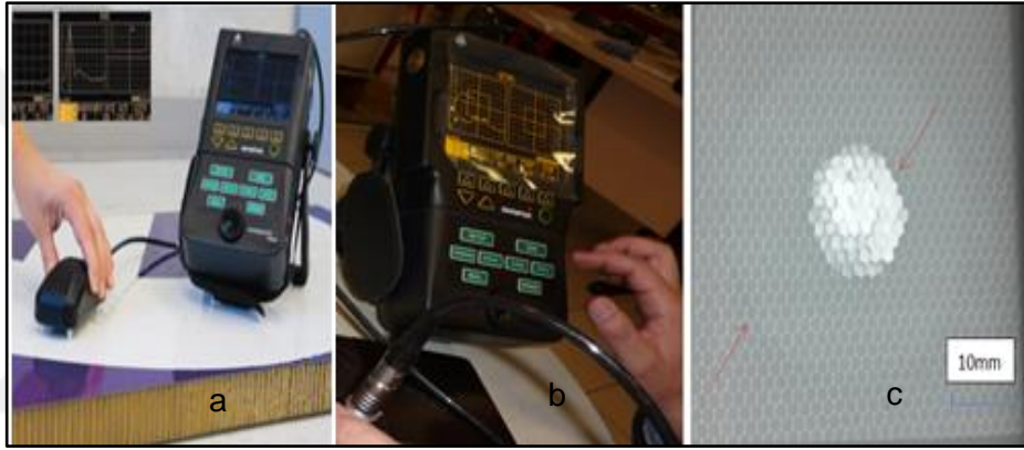
Şekil 2.3. Temsili hasarlanan bir panelin THY Teknik A.Ş. bünyesindeki tahribatsız muayene yöntemlerinden birisi ile görüntülenmesi (a) NDT cihazı (b) cihaz görüntüsü (c) numune görüntüsü
