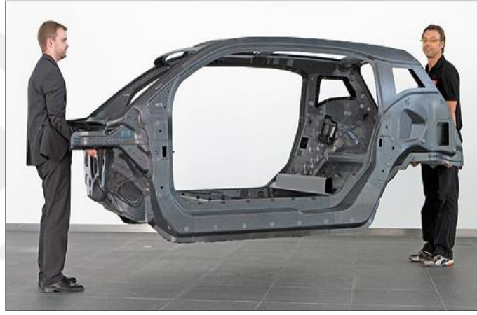
Şekil 1.6. Tek parça kompozitten üretilmiş otomobil kafes sistemi [11]
