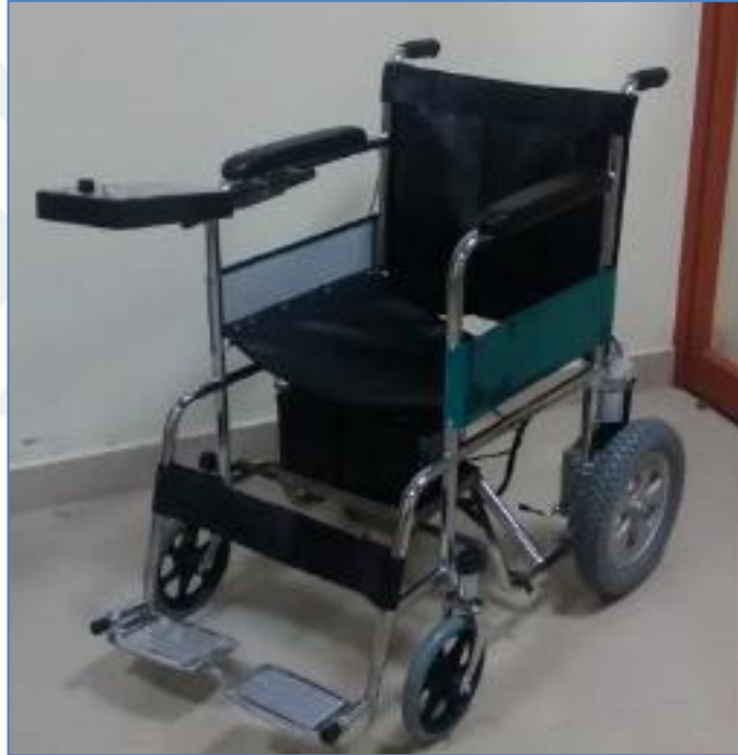
Şekil 1.16. Geliştirilen el hareketleri tabanlı tekerlekli sandalye
