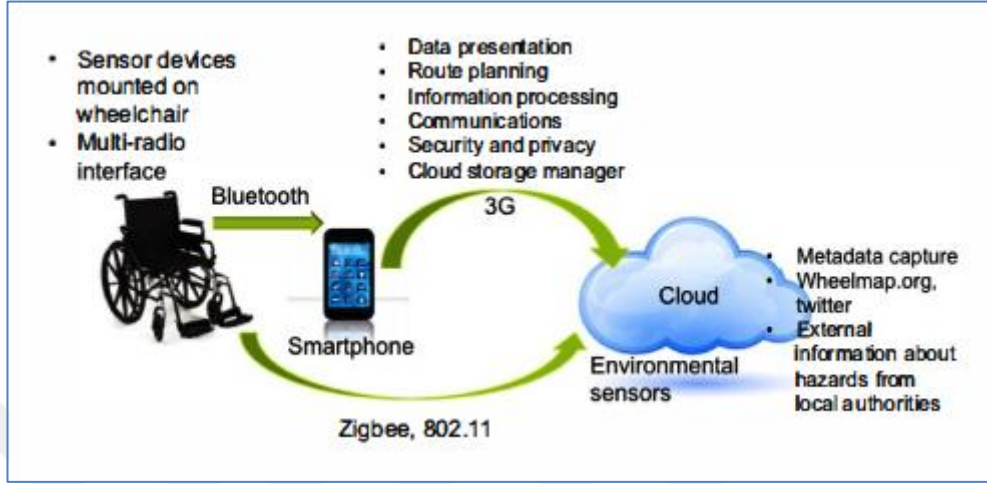
Şekil 1.17. Geliştirilen akıllı telefon tabanlı tekerlekli sandalye
