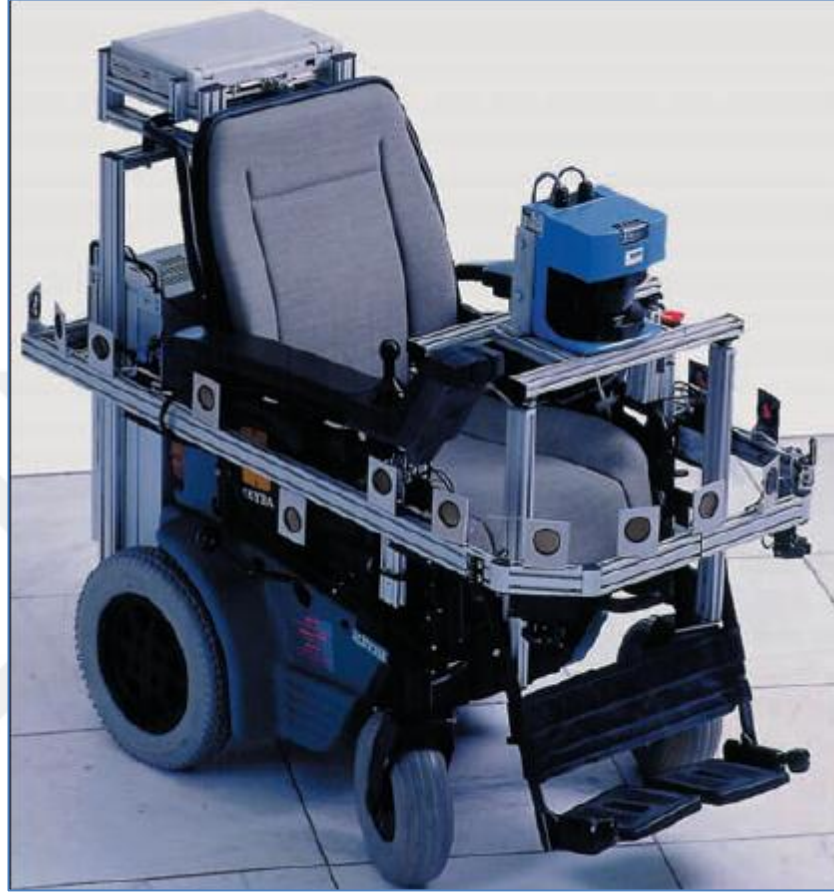
Şekil 1.12. Geliştirilen çoklu sensör destekli tekerlekli sandalye
