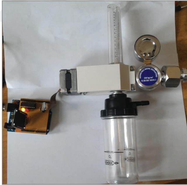
Şekil 5.8. Alıcı shield ile flowmetre kontrolü
