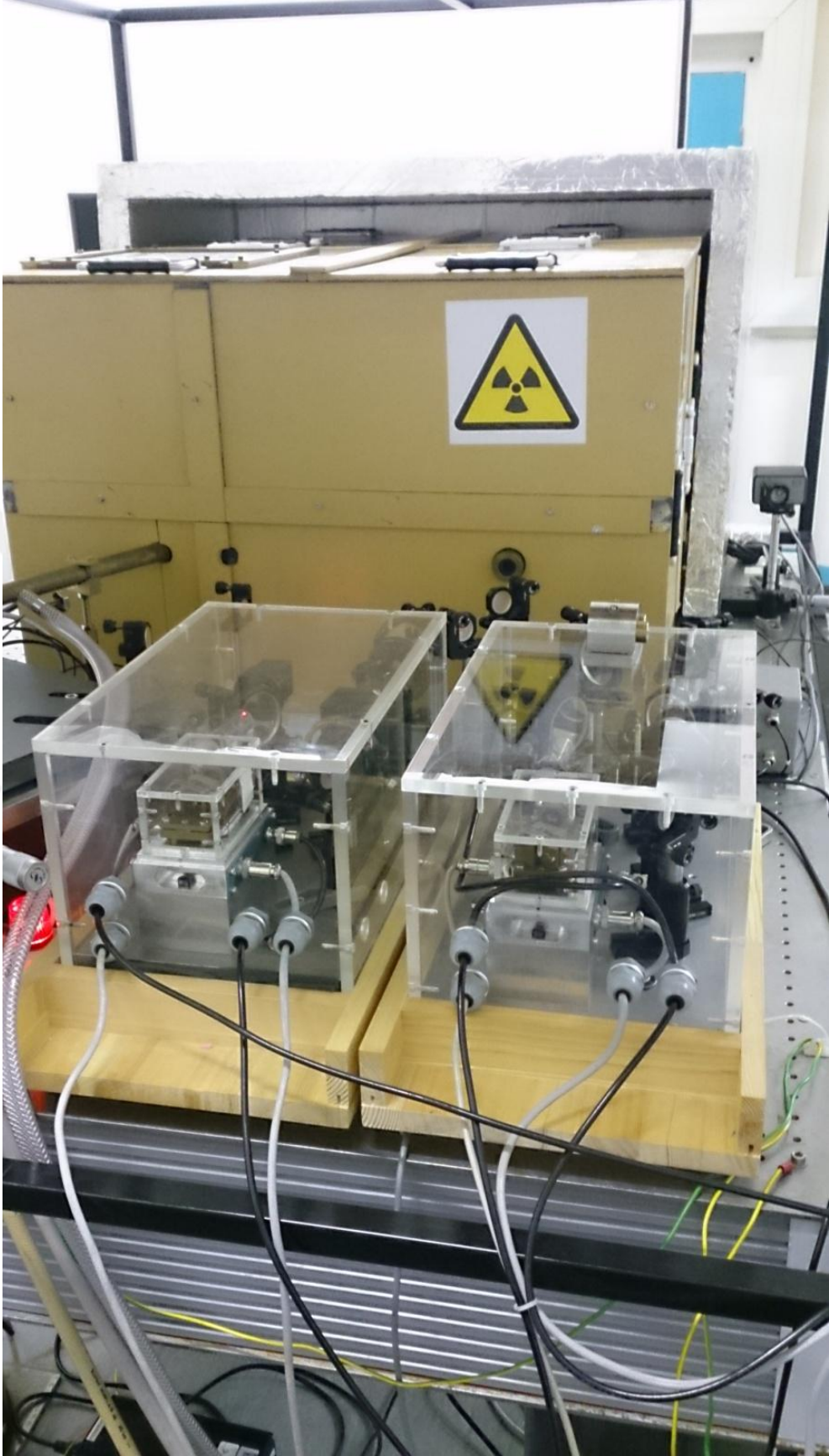
Şekil 4.17. NPL, İngiltere X-ışınları interferometresi (XRİ) ve DFPI karşılaştırma ölçümleri deney düzeneği fotoğrafı
