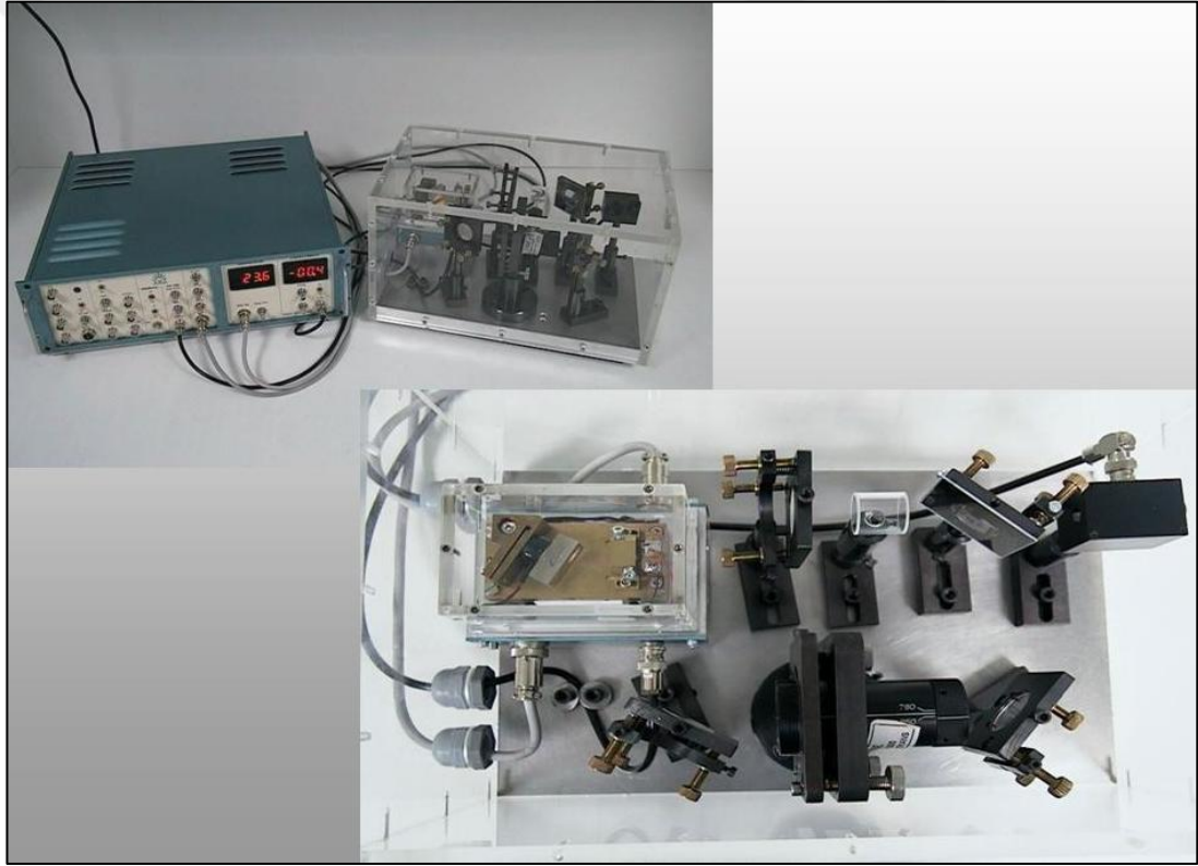
Şekil 4.5. Tamamı yerli üretim frekansı kararlı ECDL lazer sistemi ve elektronik servo kontrol ünitesi
