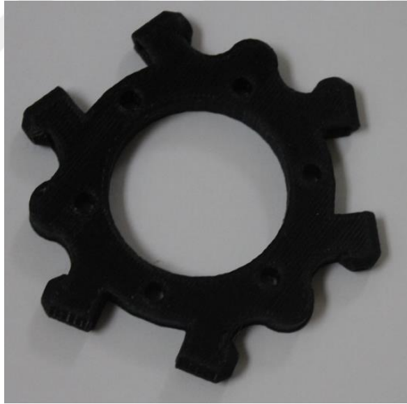
Şekil 2.11. 3B yazıcının ortasında sıcak ucu taşıyan bölüm
