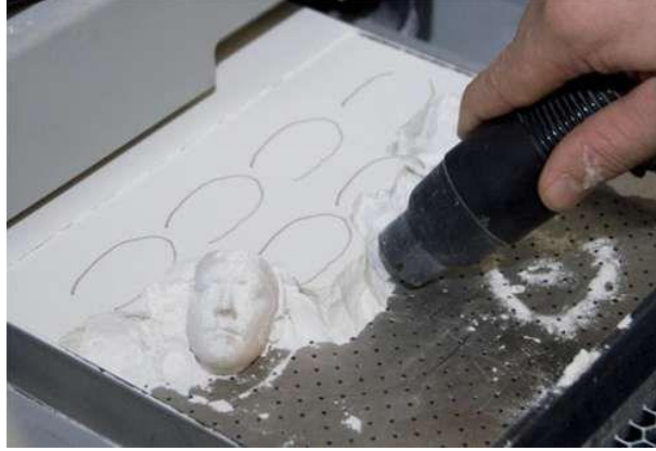
Şekil 1.3. SLS yöntemi ile üretilmiş çıktının tozlar içerisinde temizlenmesi
