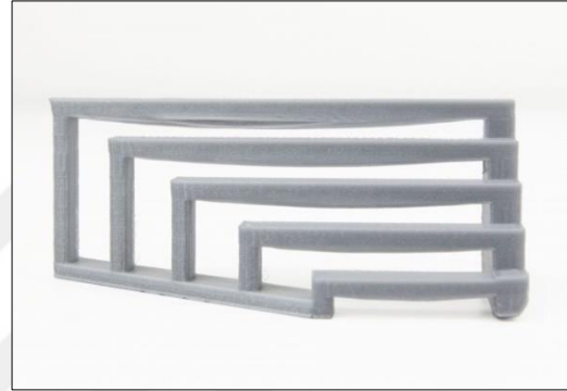
Şekil 2.55. 3B Yazıcı ürünlerinde köprü şekilleri ve bozulmalar
