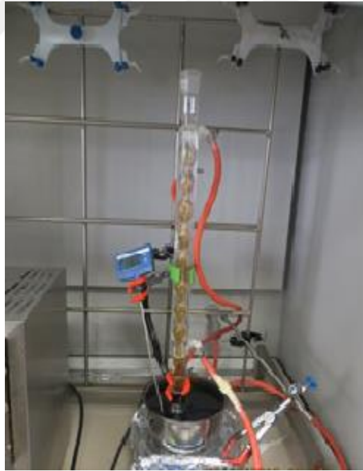
Şekil 3.2. Nanoparçacıkların oksidasyon işlemi için kurulan reflux sistemi
