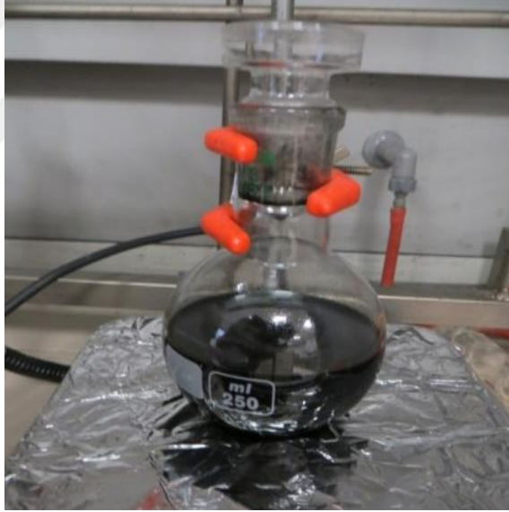
Şekil 3.4. F-MWCNT ve aşı moleküllerinin DCC varlığında esterleşme reaksiyonunda kullanılan deney düzeneği
