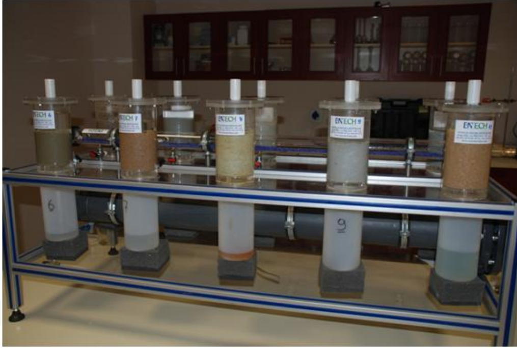
Şekil 2.10. Nem hücresi testinde, yıkama işleminde verilen ultra saf suların toplanması
