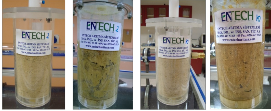
Şekil 3.109. Nem hücresi deneyinin başlangıcında ve bitiminde (52.döngü sonu), K-16 (10 numaralı hücre) K-12 (2 numaralı hücre) örneklerinin görünüm ve yapısındaki değişim
