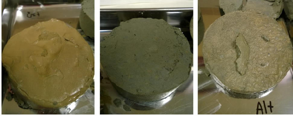
Şekil 3.126. Atık barajı örneğinde (SD-34) nem hücresi deneyi sonrasında hücrenin üst, orta ve alt kesimlerinde alınan örneklerin görünümü
