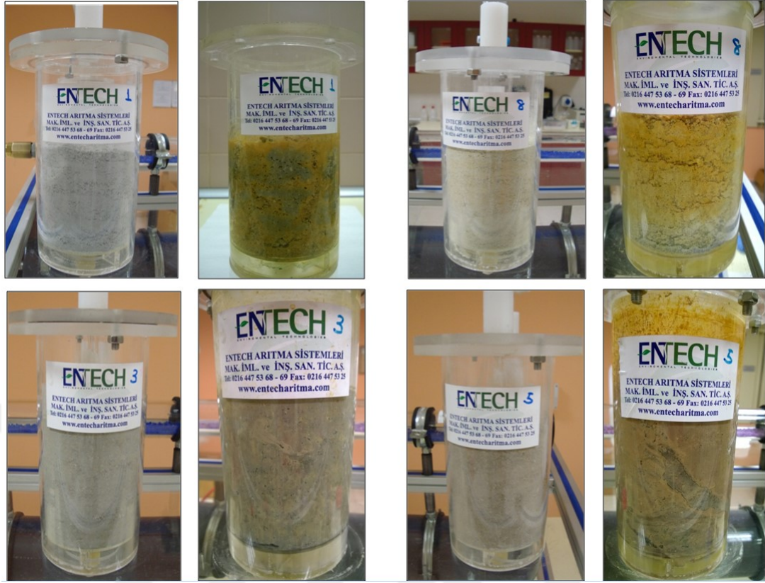
Şekil 3.92. Nem hücresi deneyinin başlangıcında ve bitiminde (52.döngü sonu), K-10 (1 numaralı hücre), K-1 (8 numaralı hücre), K-15 (3 numaralı hücre), K-17 (5 numaralı hücre) örneklerinin görünüm ve yapısındaki değişim
