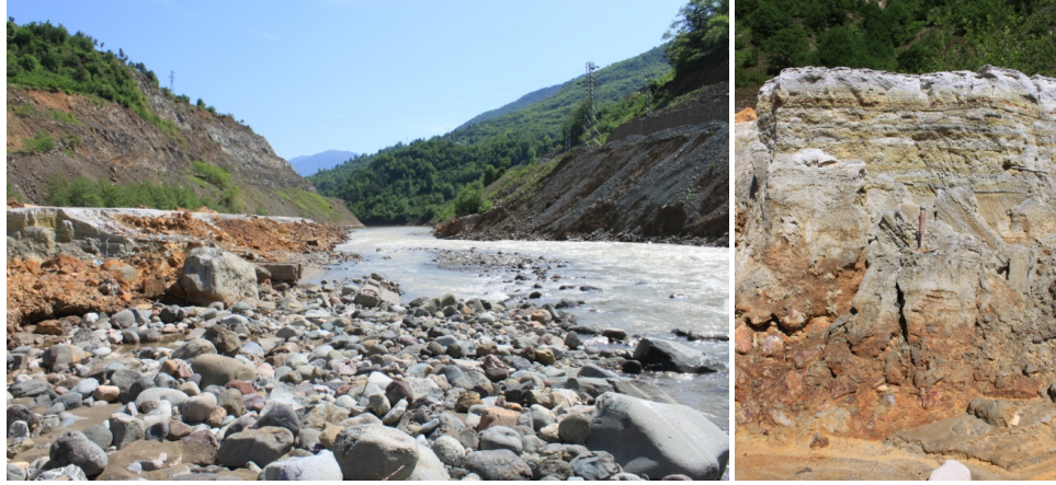
Şekil 3.55. Murgul Deresi yatağında uzun yıllar boyunca çökelmiş flotasyon atığından görünüm. Yaklaşık 2,5 m kalınlığındaki bu istifte (SD-35) kuvvetli derecede pirit oksidasyonunun izleri olan hematitleşme ve serbest kükürt oluşumları izlenmektedir
