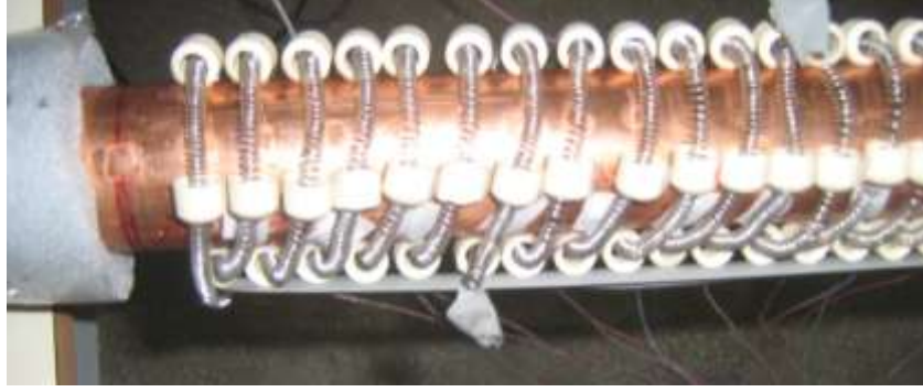
Şekil 2.16. Test bölgesinin ısıtıcı ve ısıtıcı çiftler bağlı iken görüntüsü
