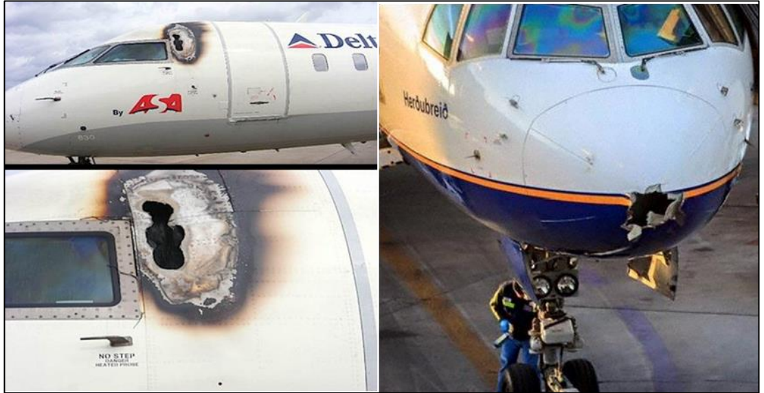
Şekil 2.3. Yıldırım sonucu oluşan hasar örnekleri [15]
