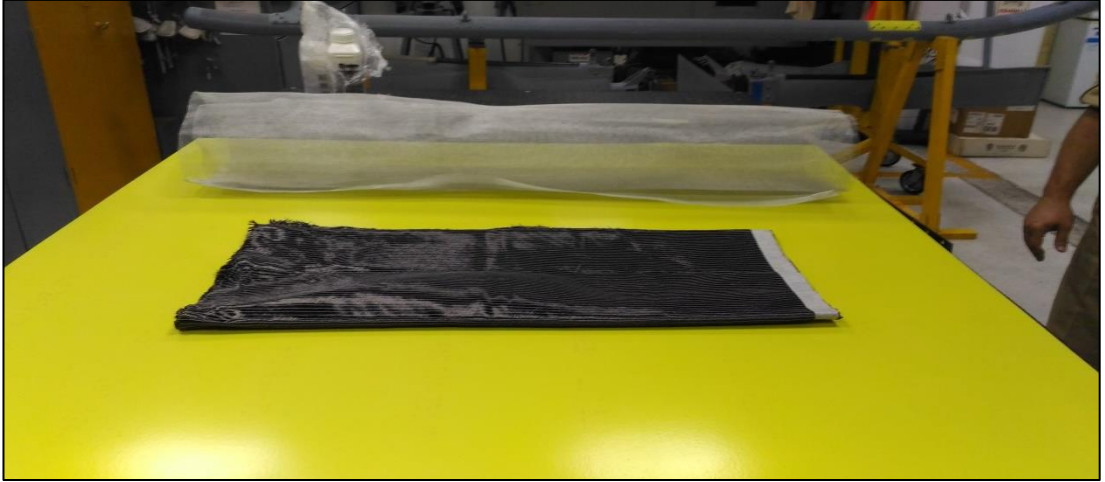
Şekil 5.8. Üretime hazır karbonfiber kumaş ve alüminyum tel örgü
