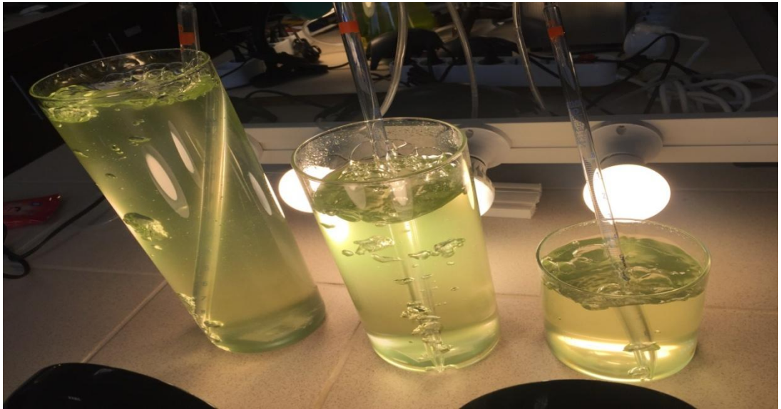
Şekil 6.29. Fotobiyoreaktör yükseklik/çap oranının etkisinin deney düzeneği
