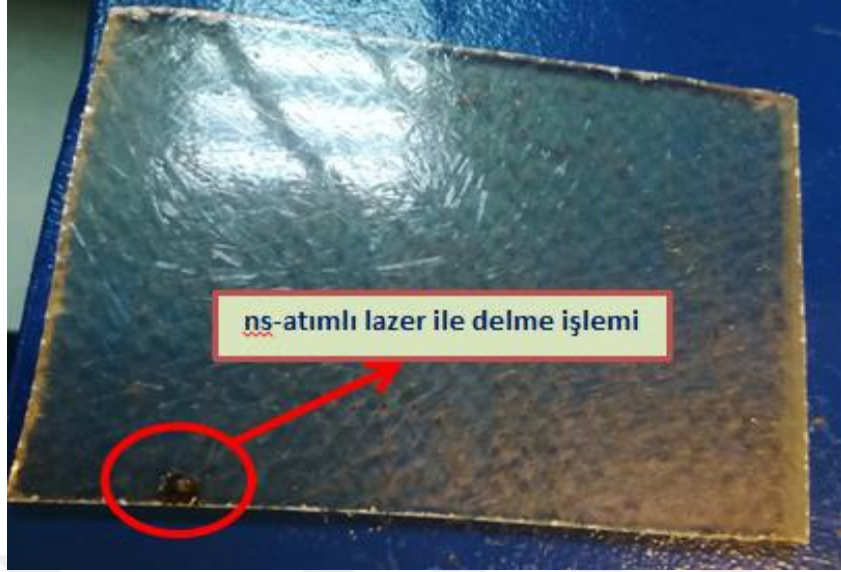
Şekil 3.11. RTM üretim yöntemi ile üretilmiş şeffaf 5 mm et kalınlığındaki CTP plaka
