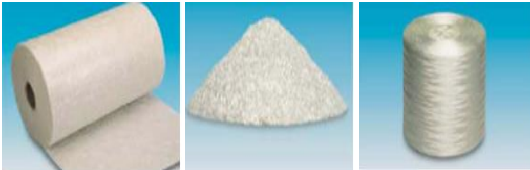
Şekil 1.4. Farklı cam elyaf türleri (a) Keçe, (b) Kırpma, (c) Fıtıl [2]
