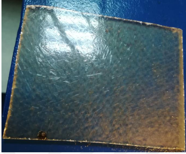
Şekil 3.6. RTM yöntemi ile üretilmiş 5 mm et kalınlığında ki şeffaf CTP plaka
