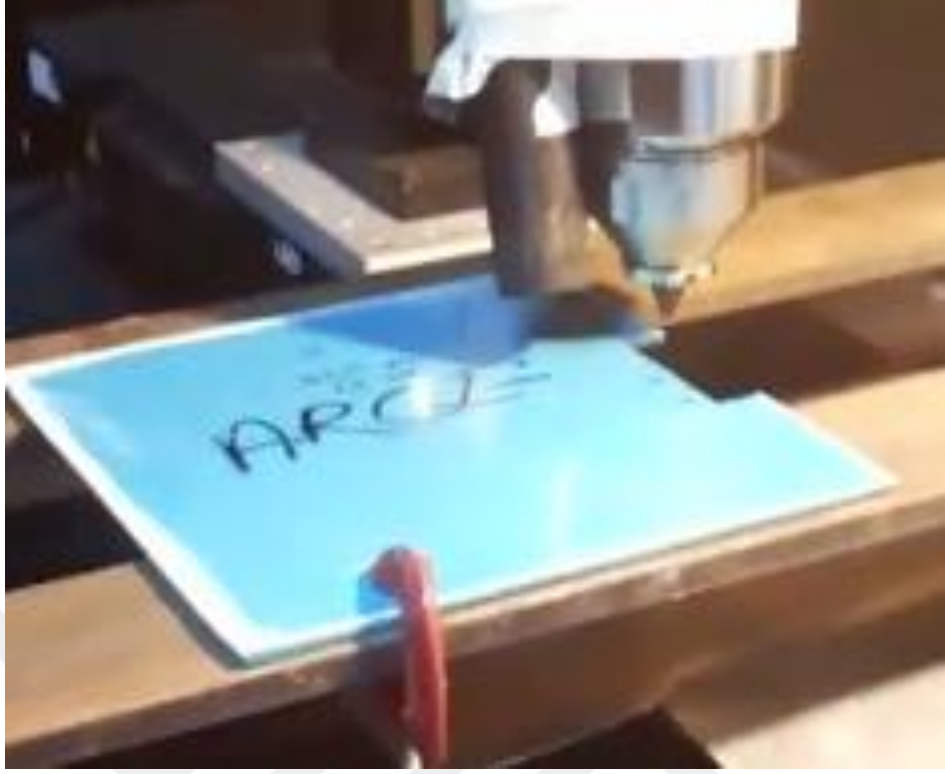
Şekil 3.7. ms-atımlı Nd:Yag lazer ile yapılan kesim işlemi mavi renkli CTP plaka (ms-atımlı lazer)
