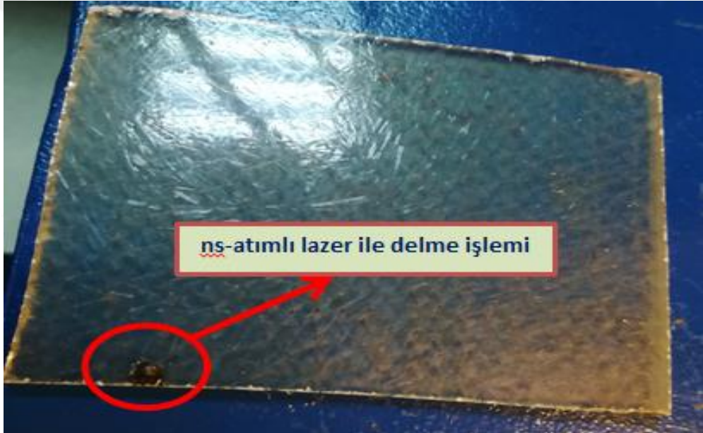
Şekil 4.1. RTM üretim yöntemi ile üretilmiş 5 mm et kalınlığındaki şeffaf CTP plaka lazer delme görüntüleri (Dalga boyu 532 nm, ns-atımlı)
