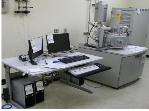
Şekil 3.7. Taramalı elektron mikroskobu (SEM) (QUANTA 400F Field Emission SEM)
